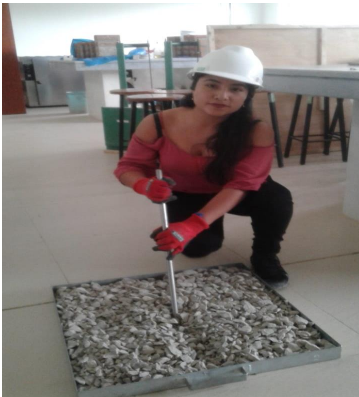
Fotografía 14. Cuarteo del agregado grueso para homogenizar la muestra.
