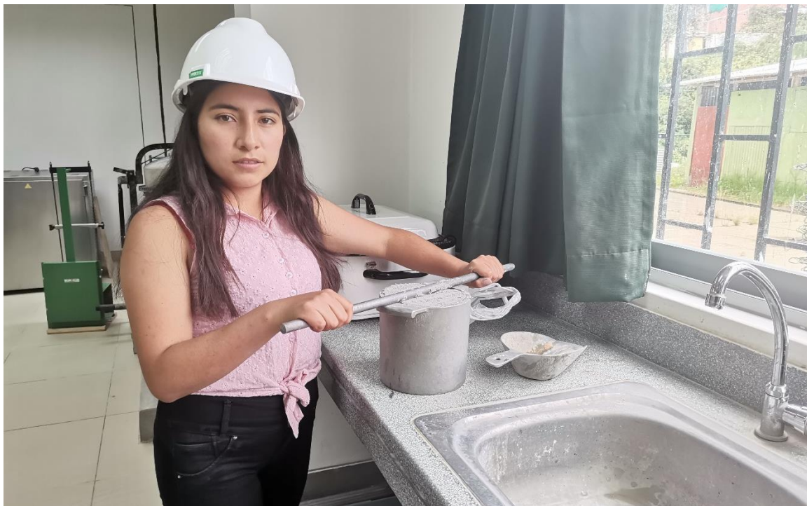
Fotografía 40. Peso unitario compactado de las conchas de abanico.
