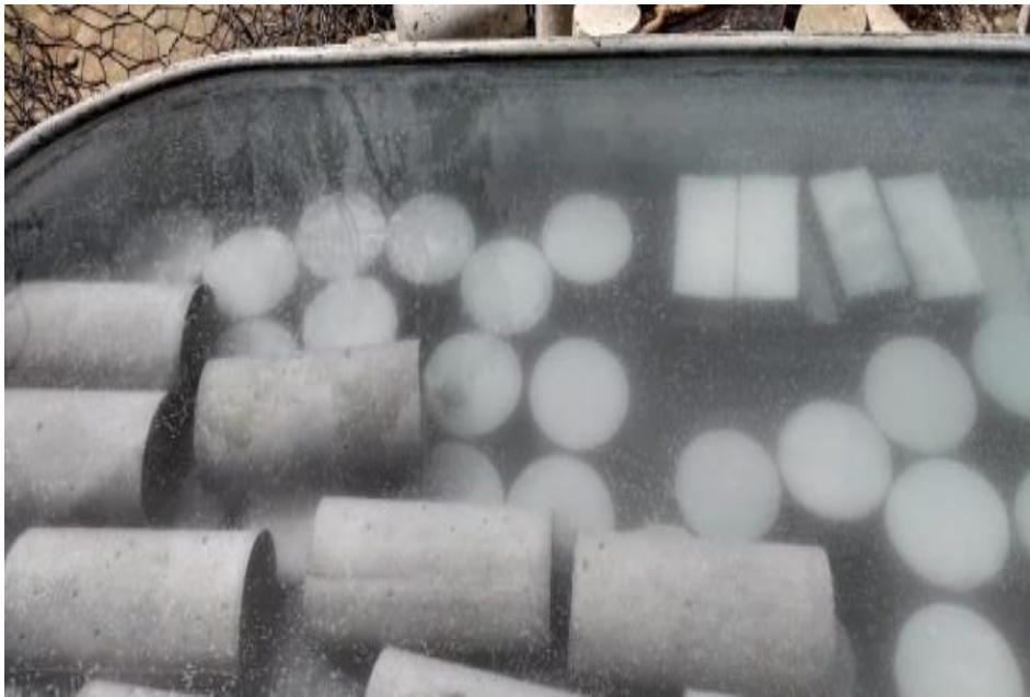
Fotografía 49: Curado de Probetas y viguetas.
