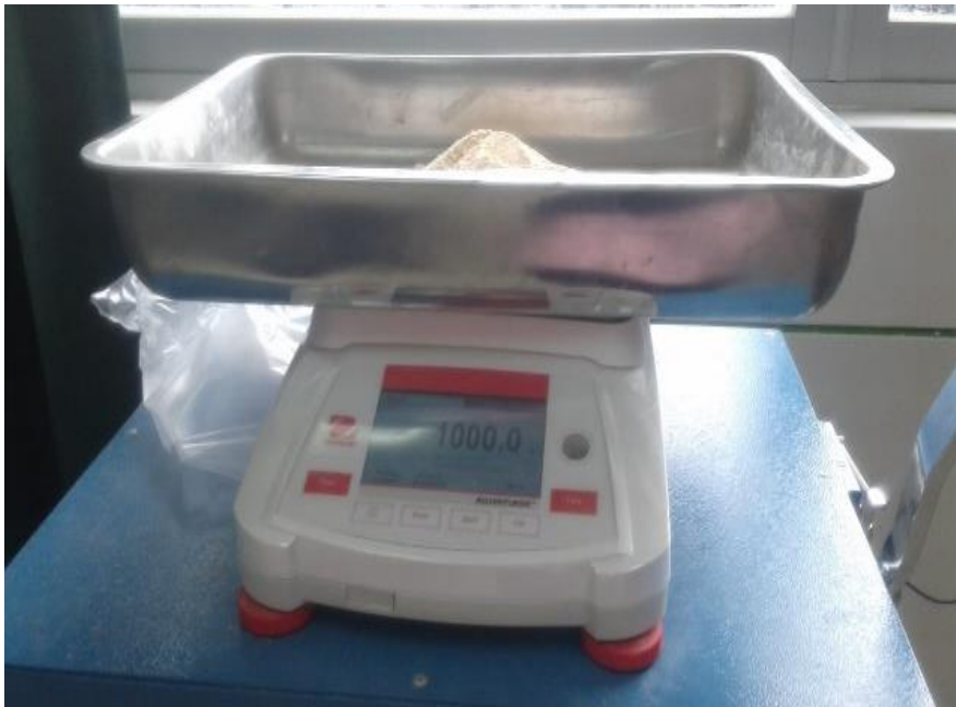
Fotografía 23. Peso de agregado fino retenido en cada malla en los diferentes tamices.
