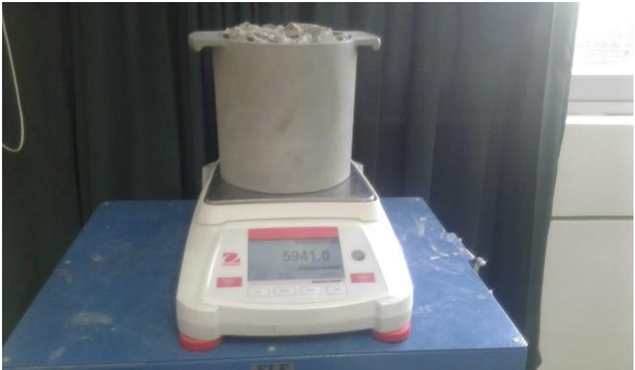
Fotografía 37. Peso del AG compactado y toma de datos.
