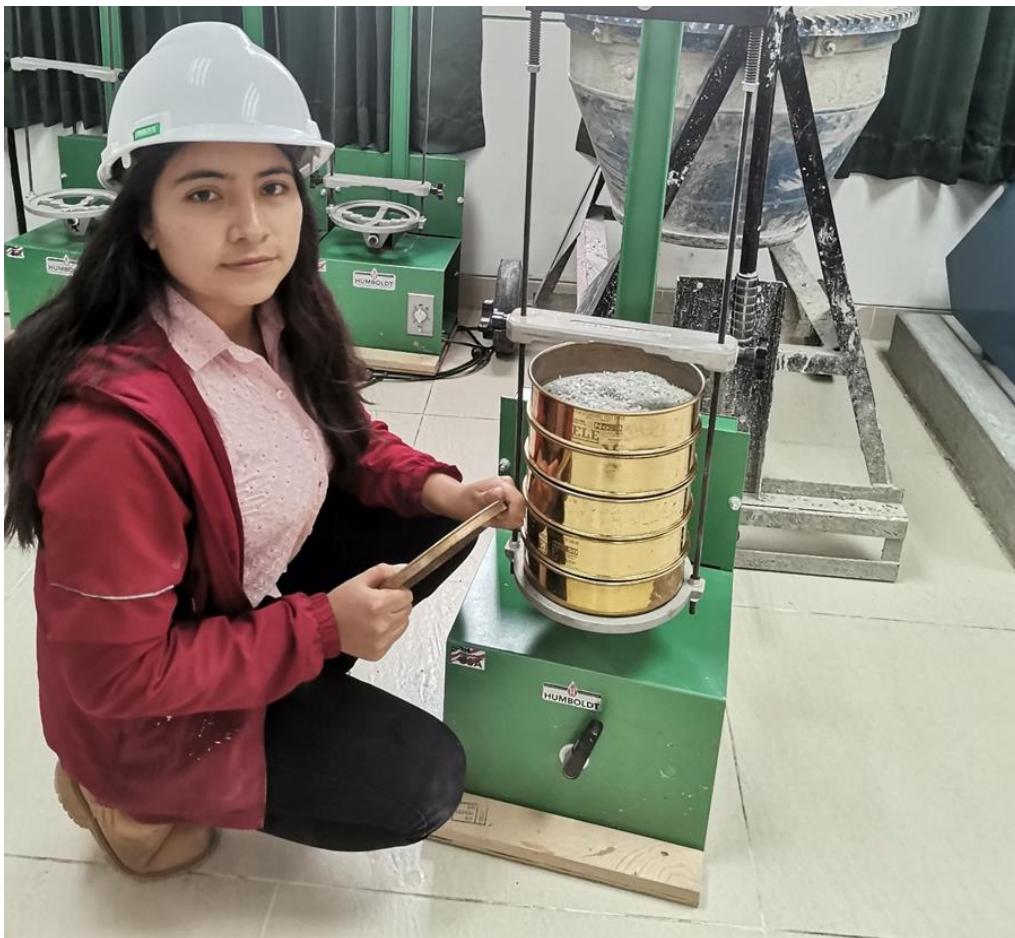
Fotografía 42. Granulometría de elementos PET.
