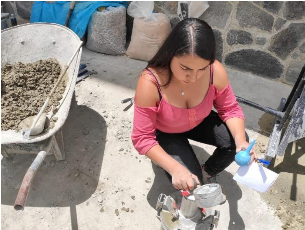
Fotografía 48. Elaboración de viguetas con diferentes porcentajes de residuos de conchas de abanico y PET.
