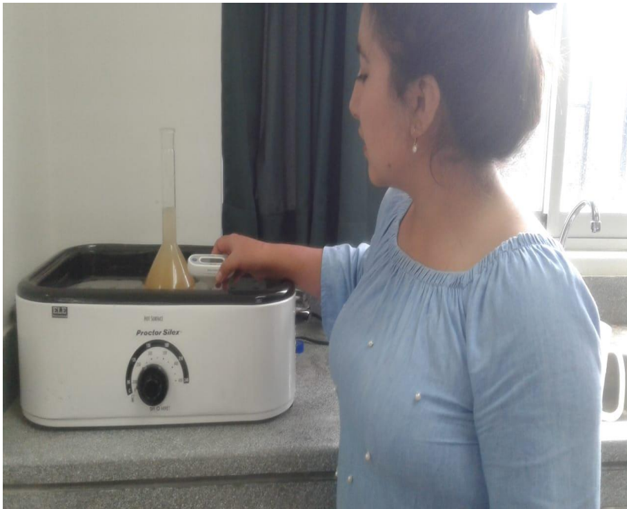
Fotografía 31. Baño maría para sacar las burbujas contenidas en la muestra.
