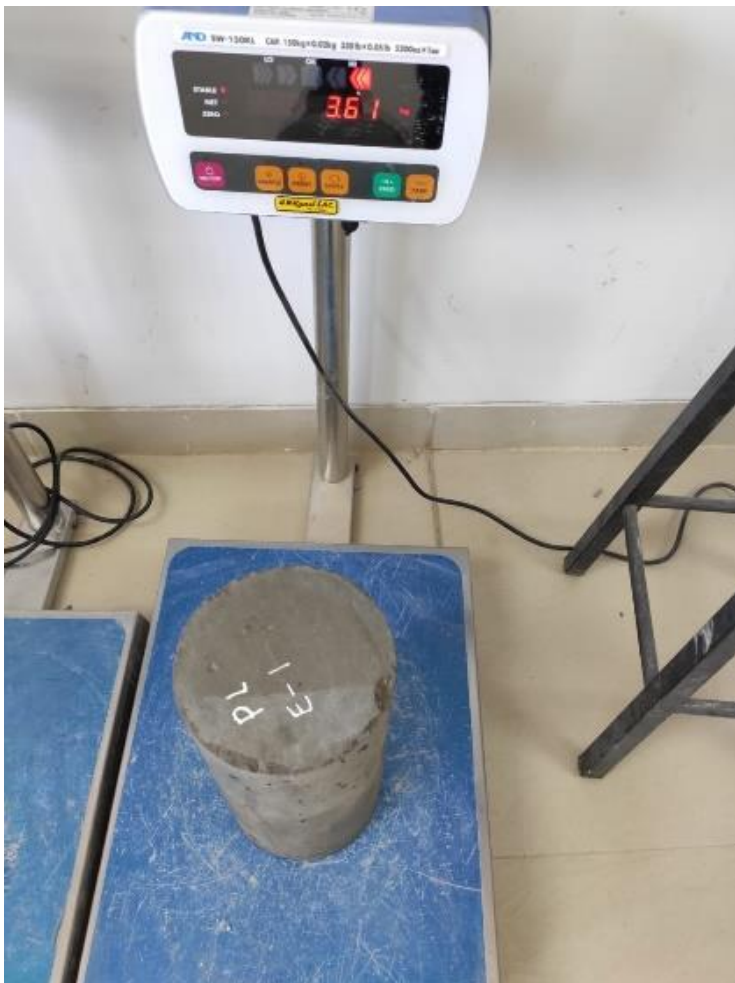
Fotografía 50. Peso de probetas a los 7, 14 y 28 días
