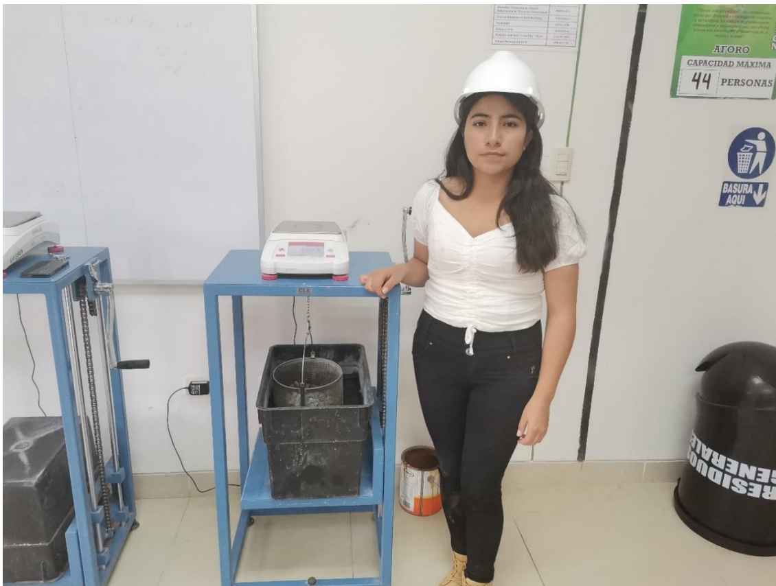
Fotografía 24. Peso específico de agregado grueso. Se sumerge el material en agua por 24 h para poder saturarlo completamente.
