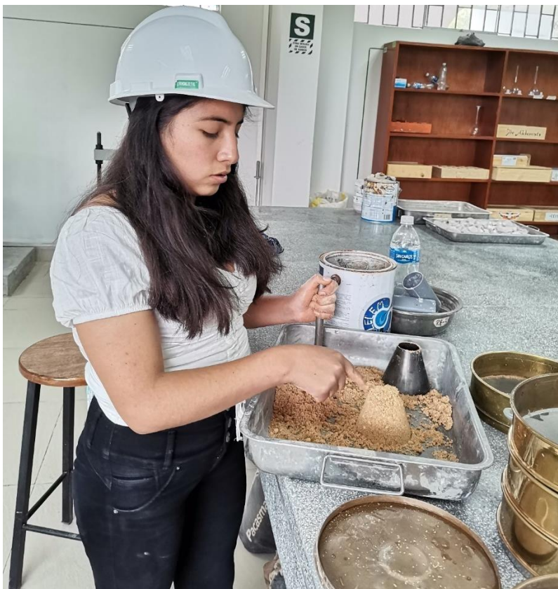
Fotografía 28. Encontrando el peso específico con superficie seca del agregado fino.
