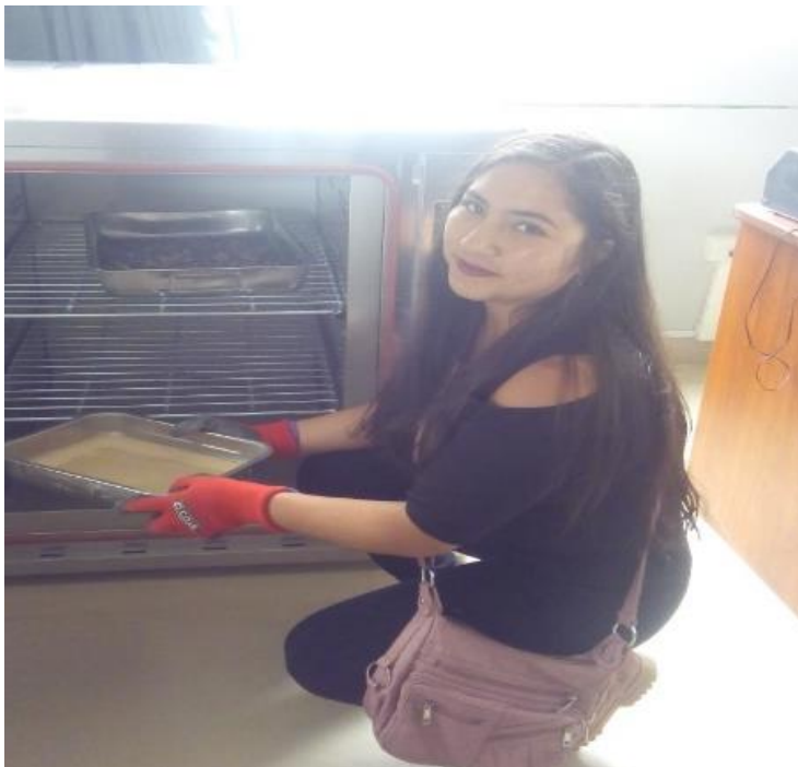
Fotografía 20. Secado del material a 105 \pm 5 grados Celsius por un tiempo de 24 h.
