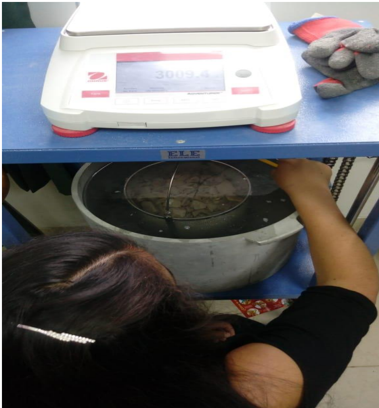
Fotografía 28. Encontrando el peso específico con superficie seca del agregado fino.
