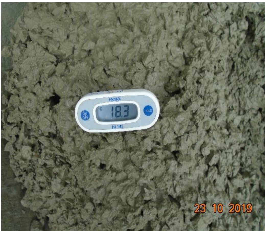
Fotografía 46. Medición de la Temperatura del concreto.
