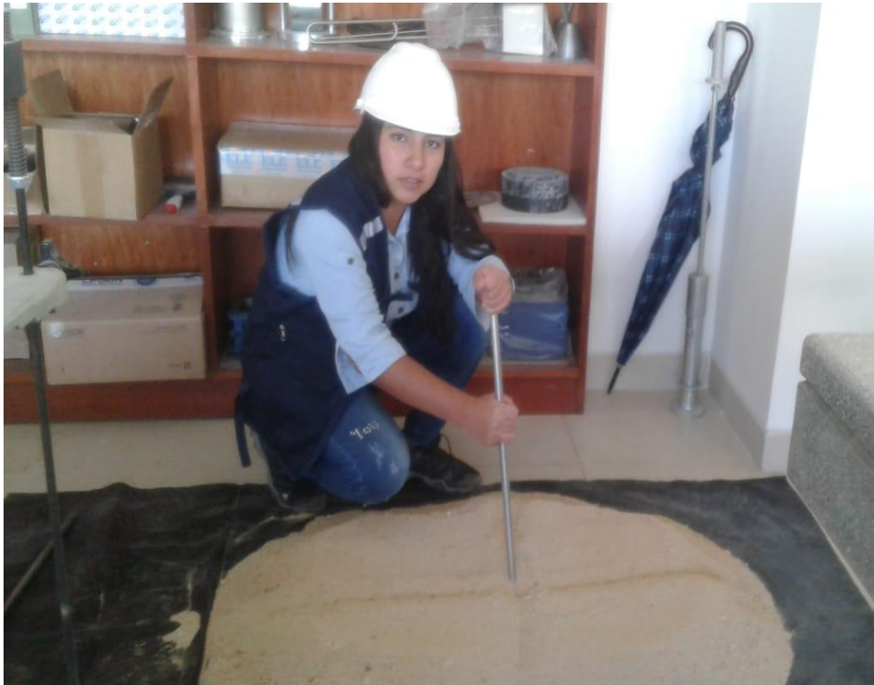
Fotografía 19. Cuarteo del agregado fino para poder homogenizar la muestra y que los ensayos salgan mucho más exactos.
