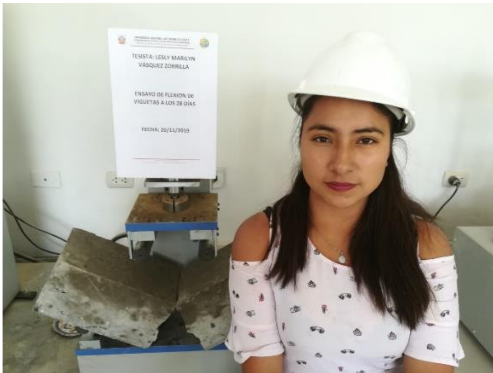
Fotografía 58. Medición de la rotura de las viguetas y probetas para ver el tipo de falla.
