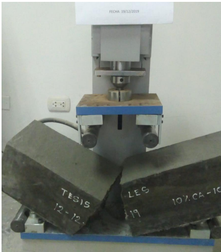
Fotografía 53. Rotura de probetas a los 7, 14 y 28 días.
