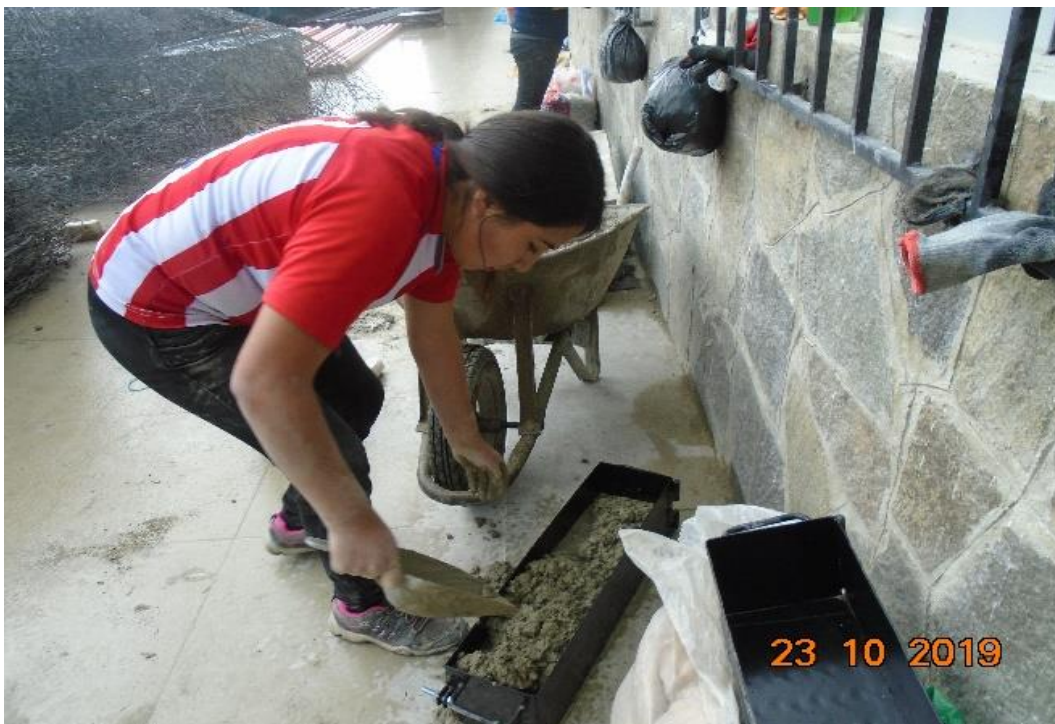
Fotografía 48. Elaboración de viguetas con diferentes porcentajes de residuos de conchas de abanico y PET.
