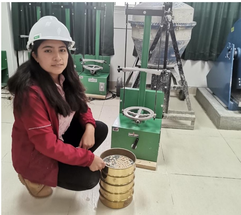
Fotografía 22. Ensayo de granulometría del agregado fino por los tamices.
