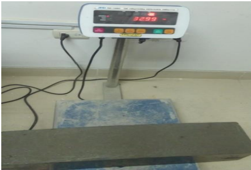
Fotografía 51. Peso de probetas a los 7, 14 y 28 días
