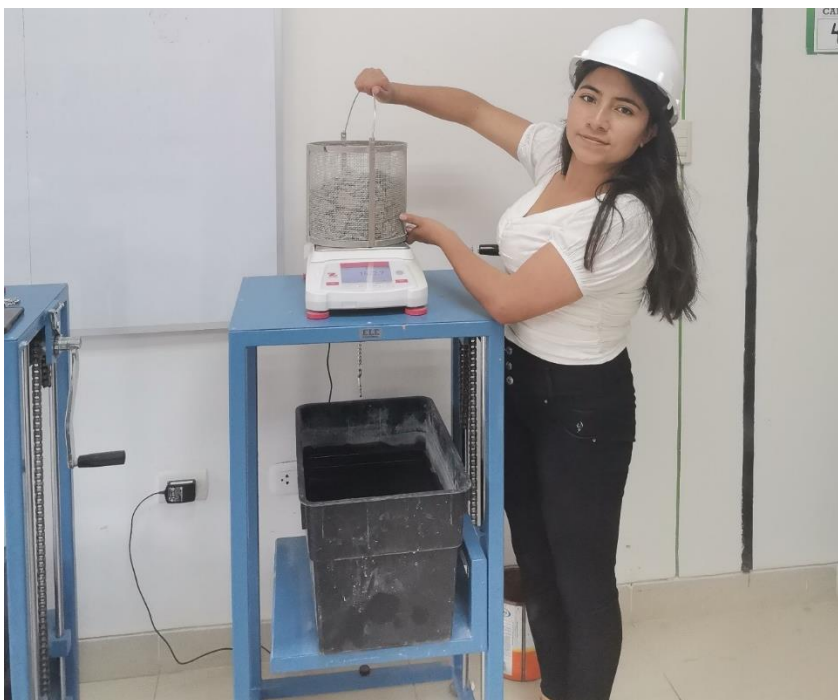
Fotografía 26. Se procede a pesar el material completamente saturado con superficie seca
