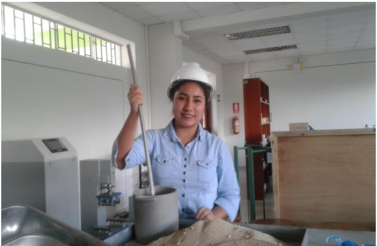
Fotografía 38. Ensayo de compactado del AF para el peso unitario.
