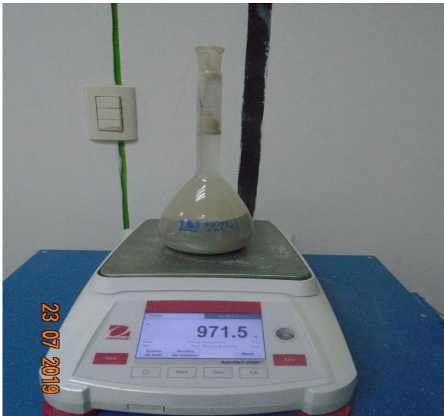
Fotografía 39. Peso de fiola más cenizas de conchas de abanico más agua.
