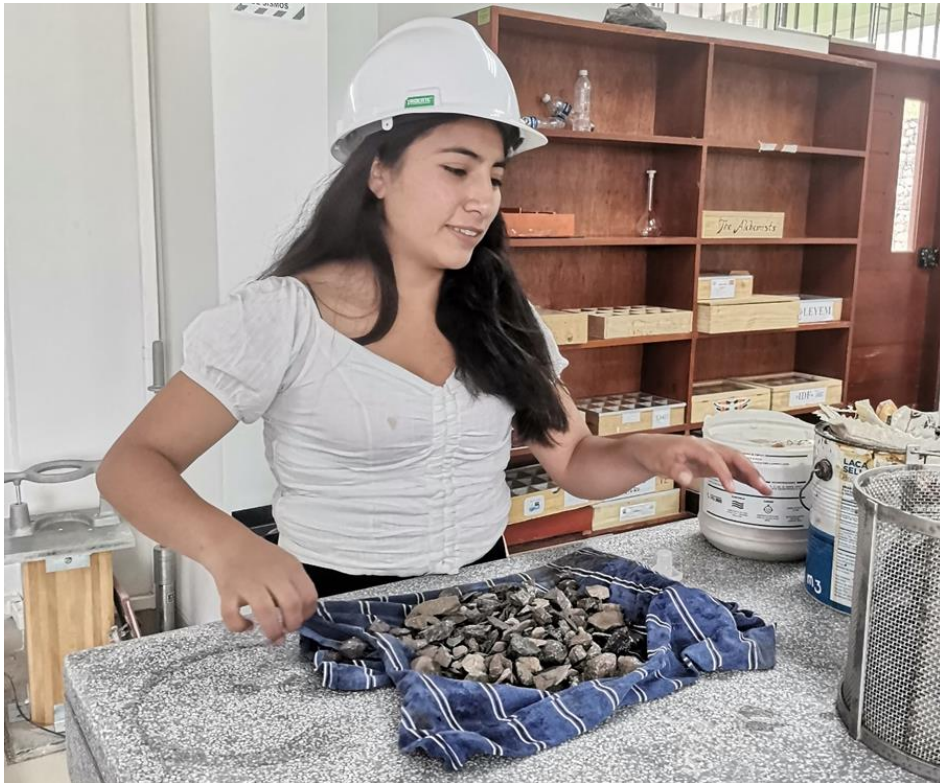
Fotografía 25. Se seca la piedra con una franela para dejarla con la superficie seca pero que en su interior los poros estén completamente saturados.
