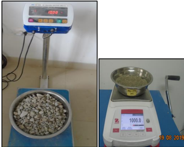
Foto N° 25. Izquierda. Reducción de muestra mínima para ensayo granulométrico de grava de río Chotano.
