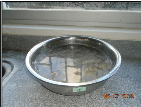
Foto N° 46. Izquierda. Preparación de agregado grueso para ensayo de densidad relativa Foto N° 47. Derecha. Agregado grueso de cantera de cerro (San Juan del Suro) puesto a saturar por 24h.
