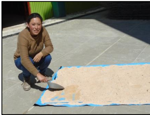
Foto N° 19. Izquierda. Secado de agregado fino de cerro, para análisis granulométrico.
