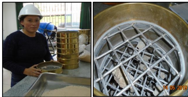
Foto N° 27. Izquierda. Tamizado de agregado fino de cerro.
