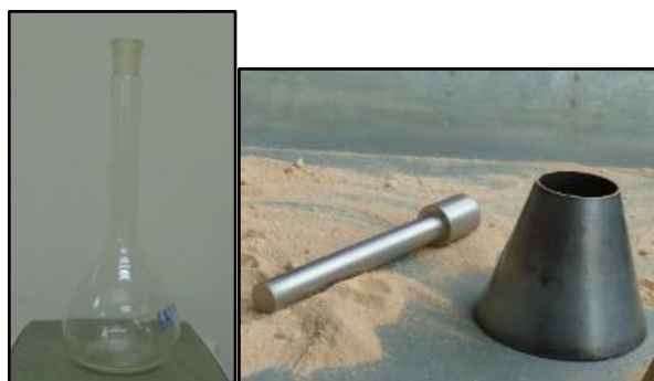
Foto N° 17. Izquierda. Fiola con capacidad de 500 ml.
