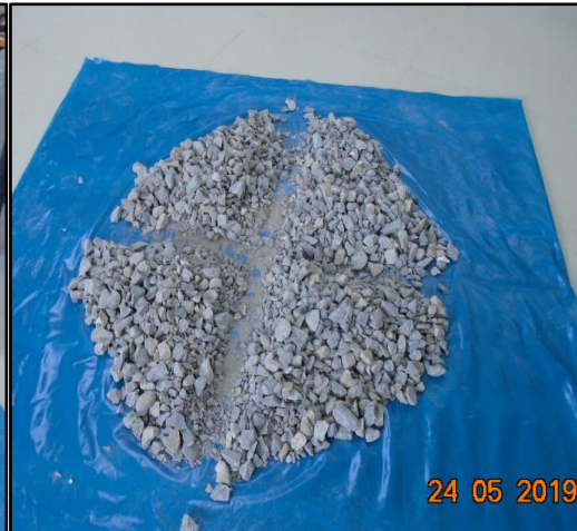
Foto N° 21. Izquierda Superior. Cuarteo de agregado fino de río Doña Ana.
