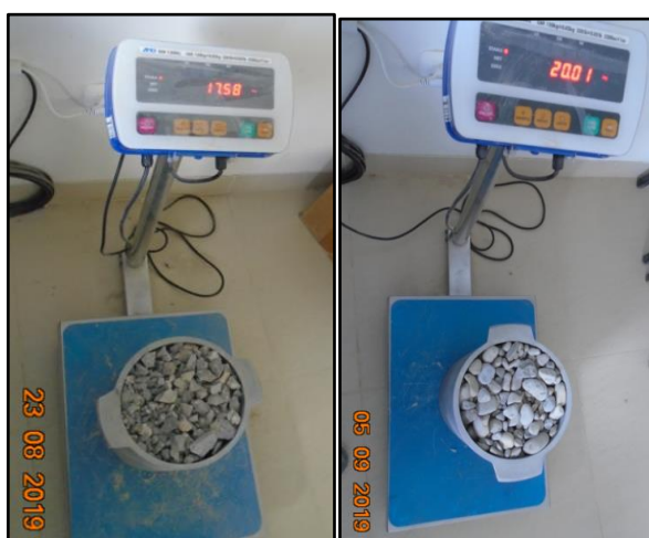
Foto N° 33. Izquierda. Lectura de masa de recipiente más masa del agregado grueso de cerro (Cantera Los Reyes) para ensayo de densidad de masa seco suelto.
