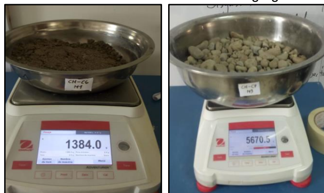
Foto N° 55. Izquierda. Lectura de masa de recipiente más masa de muestra de agregado fino (Cantera río Chotano), para determinar la humedad del agregado. Foto N° 56. Derecha. Lectura de masa de recipiente más masa de muestra de agregado grueso (Cantera río Chotano), para ensayo de contenido de humedad.
