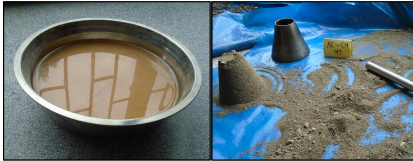
Foto N° 50. Izquierda. Agregado fino de cantera de cerro (Conchán) saturado por 24h. Foto N° 51. Derecha. Ensayo de humedad superficial para obtener un estado superficialmente seco del agregado fino de río Doña Ana.
