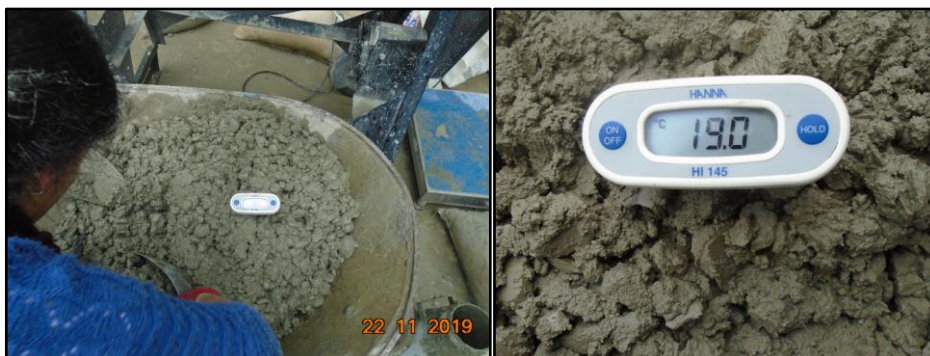
Foto N° 61. Izquierda. Lectura de temperatura en mezcla con agregados de río. Foto N° 62. Derecha. Lectura de temperatura en mezcla con agregados de cerro.
