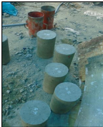
Foto N° 73. Izquierda. Desmolde de probetas pasadas las 24 h después de elaboración. Foto N° 74. Derecha. Poza de curado de probetas.
