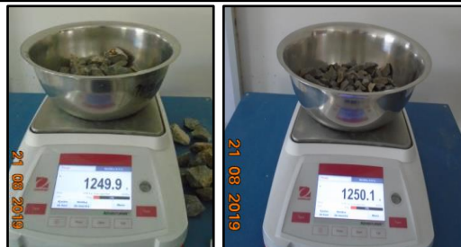
Foto N° 41, 42 y 43. Reducción de muestra de agregado grueso de cerro (Cantera Los Reyes), según gradación A.
