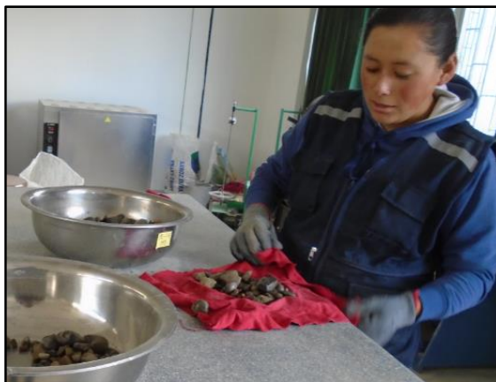
Foto N° 48. Izquierda. Obtención de muestra en estado superficialmente seco. Foto N° 49. Derecha. Lectura de masa de canastilla más masa de muestra de agregado grueso saturado superficialmente seco.
