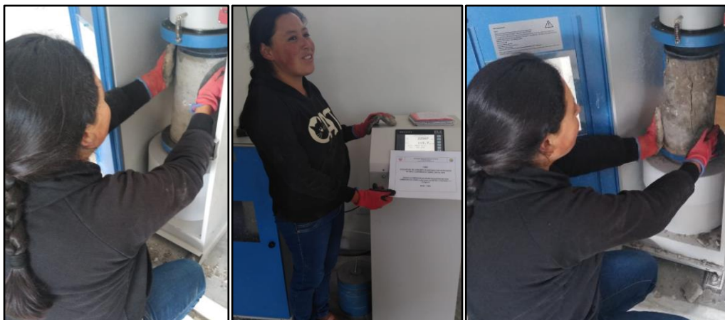
Foto N° 75, N° 76 y N° 77. Colocación, lectura de resistencia y retiro de probeta de la máquina de compresión.
