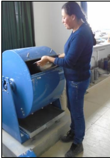
Foto N° 44. Izquierda. Colocación de muestra en la Maquina de los Ángeles. Foto N° 45. Derecha. Tamizado de material resultante del ensayo de abrasión.
