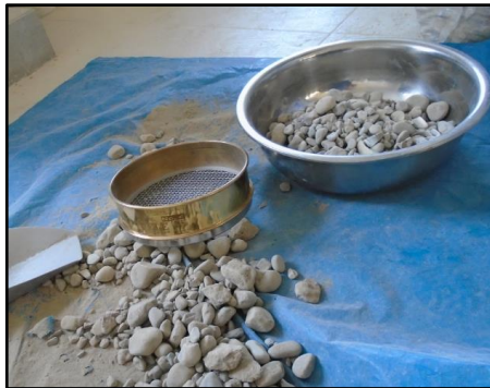
Foto N° 46. Izquierda. Preparación de agregado grueso para ensayo de densidad relativa Foto N° 47. Derecha. Agregado grueso de cantera de cerro (San Juan del Suro) puesto a saturar por 24h.
