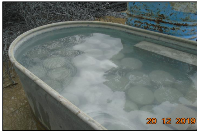
Foto N° 73. Izquierda. Desmolde de probetas pasadas las 24 h después de elaboración. Foto N° 74. Derecha. Poza de curado de probetas.
