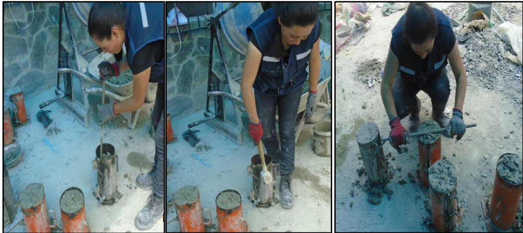
Foto N° 70, N° 71 y N° 72. Llenado, compactado y enrazado de probetas.
