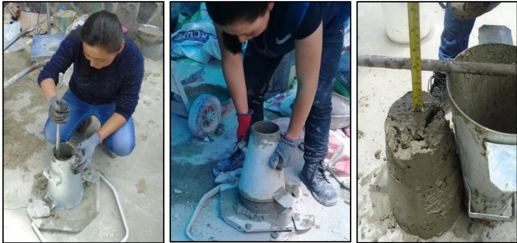
Foto N° 63, N° 64 y N° 65. Desarrollo del ensayo de asentamiento.
