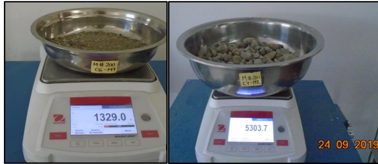
Foto N° 37. Izquierda. Lectura de masa de recipiente más masa del agregado fino de río Chotano antes de ser lavado.
