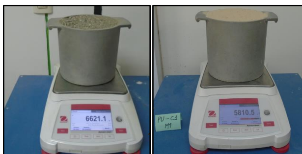
Foto N° 31. Izquierda. Lectura de masa de recipiente más masa del agregado fino de río Chotano para determinar la densidad de masa seco compactado.
