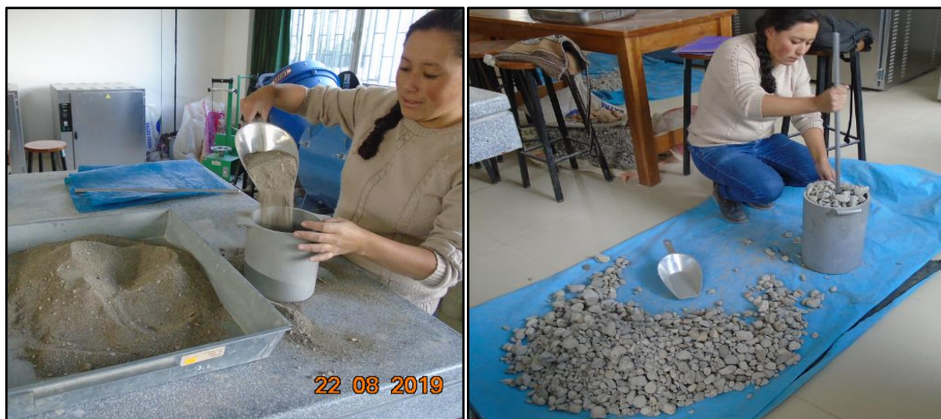
Foto N° 29. Izquierda. Rellenado del molde para ensayo de densidad de masa seco suelto de arena de río Doña Ana.
