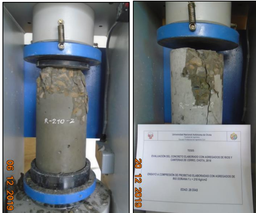
Foto N° 85. Izquierda. Fractura Tipo 6 en probeta elaborada con agregado de río Doña Ana ensayado a los 14 días.
