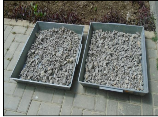
Foto N° 19. Izquierda. Secado de agregado fino de cerro, para análisis granulométrico.
