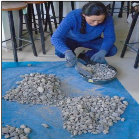
Foto N° 21. Izquierda Superior. Cuarteo de agregado fino de río Doña Ana.
