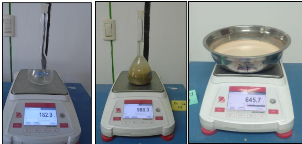
Foto N° 52. Izquierda. Lectura de masa de fiola. Foto N° 53. Centro. Lectura de masa de fiola más masa de muestra y masa de agua, (Cantera río Chotano). Foto N° 54. Derecha. Lectura de masa de muestra de agregado fino seca al horno.
