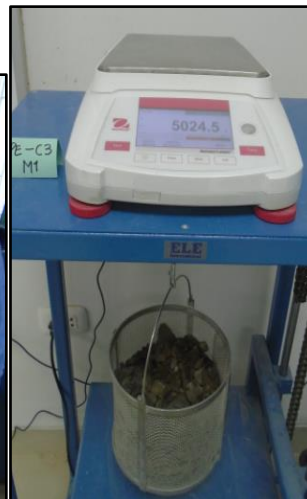
Foto N° 48. Izquierda. Obtención de muestra en estado superficialmente seco. Foto N° 49. Derecha. Lectura de masa de canastilla más masa de muestra de agregado grueso saturado superficialmente seco.
