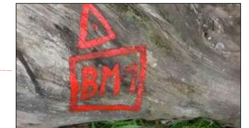
VISTA DEL BM N° 01 SOBRE ROCA FIJA
