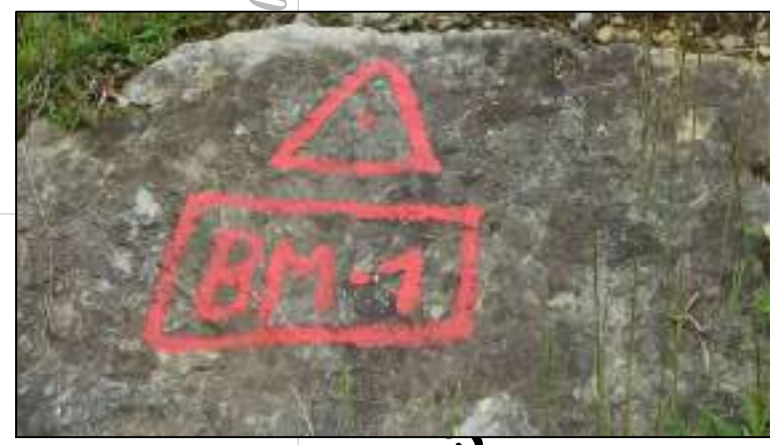
VISTA DEL BM N° 01 SOBRE ROCA FIJA
