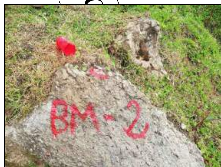
VISTA DEL BM N° 02 SOBRE ROCA FIJA
