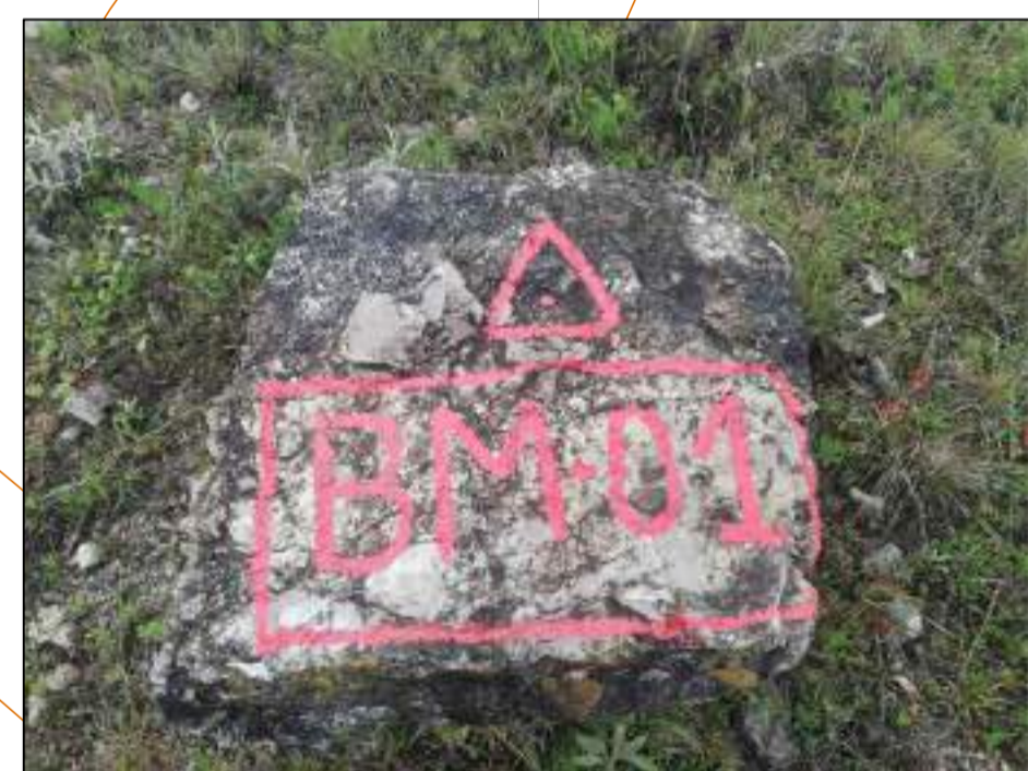
VISTA DEL BM N° 01 SOBRE ROCA FIJA
