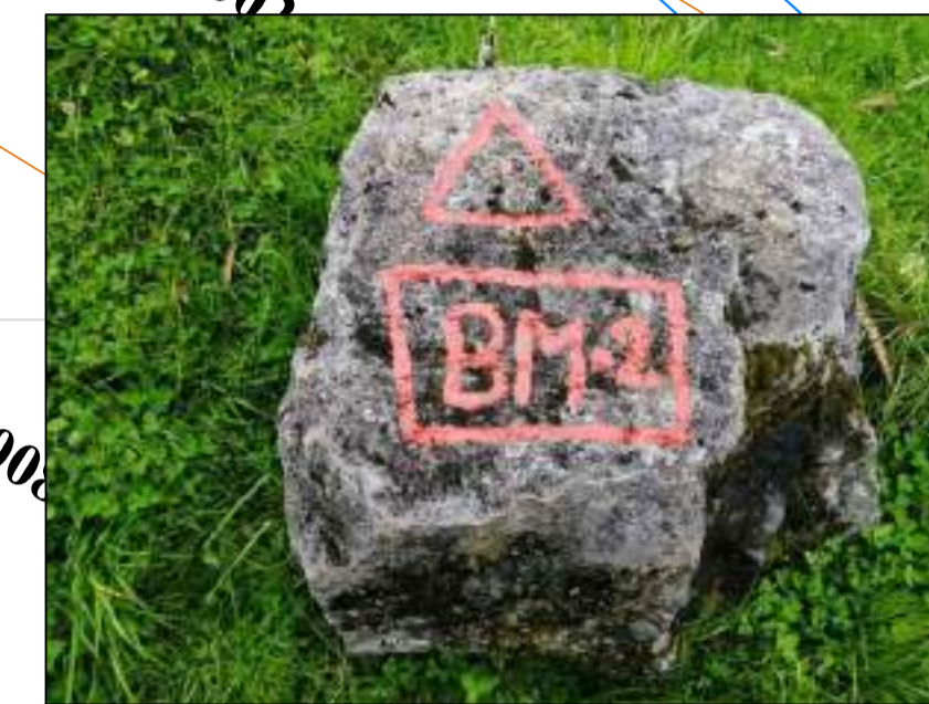
VISTA DEL BM N° 02 SOBRE ROCA FIJA
