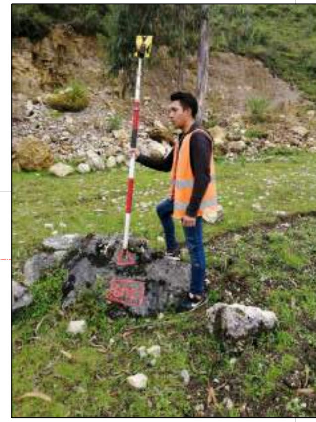
VISTA PANORÁMICA DEL BM N° 02 SOBRE ROCA FIJA
