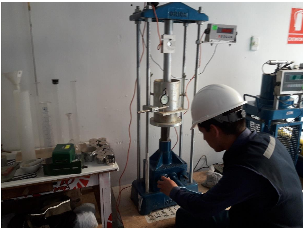
Fotografía 14. Ensayo CBR de laboratorio
