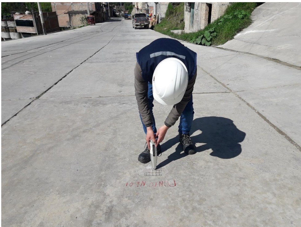
Fotografía 6. Aplicación del ensayo de esclerometría en la Av. Micaela Bastidas, Chota
