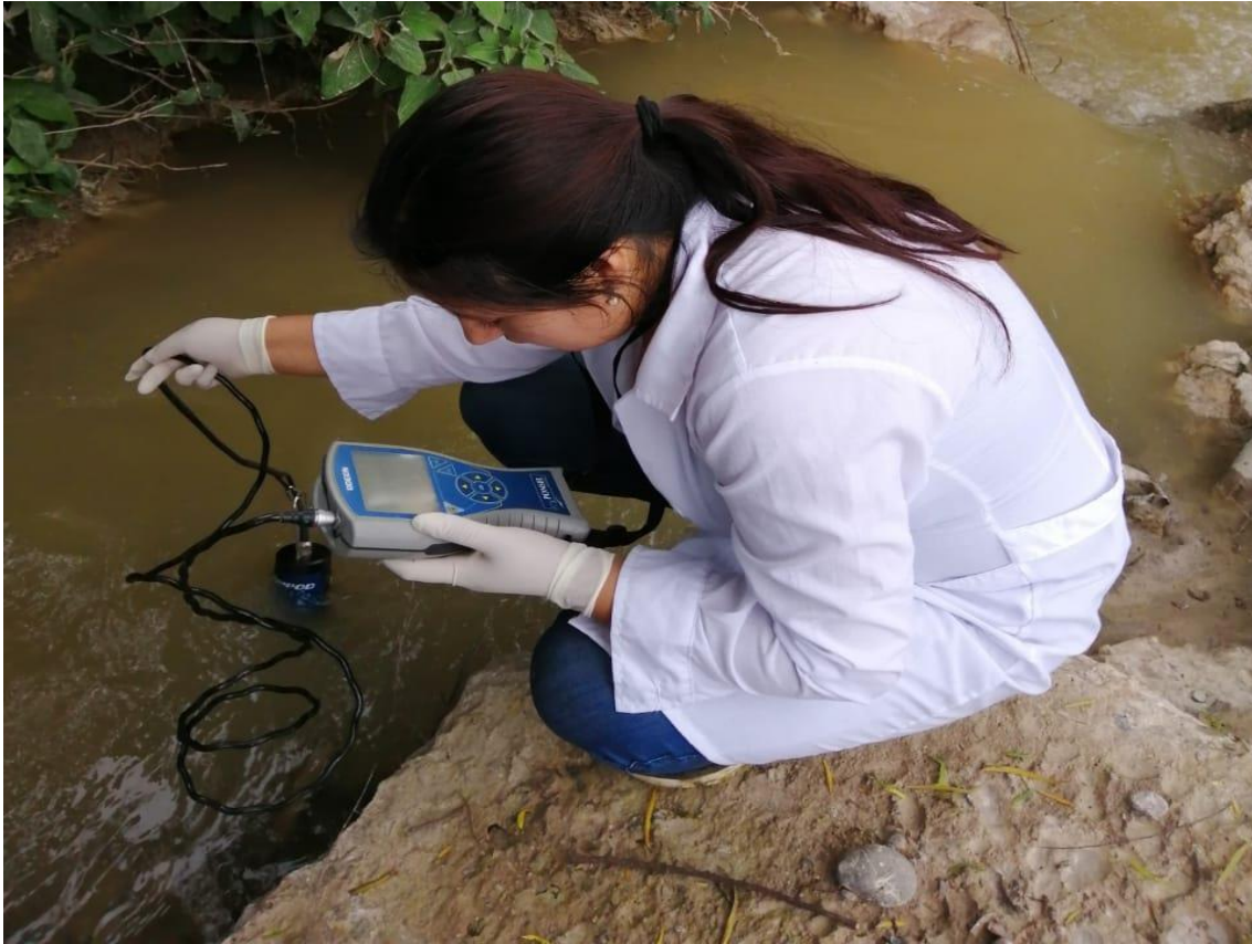
Figura 19. Determinación de la concentración de parámetros con el multiparámetro en la estación QSmat.02
