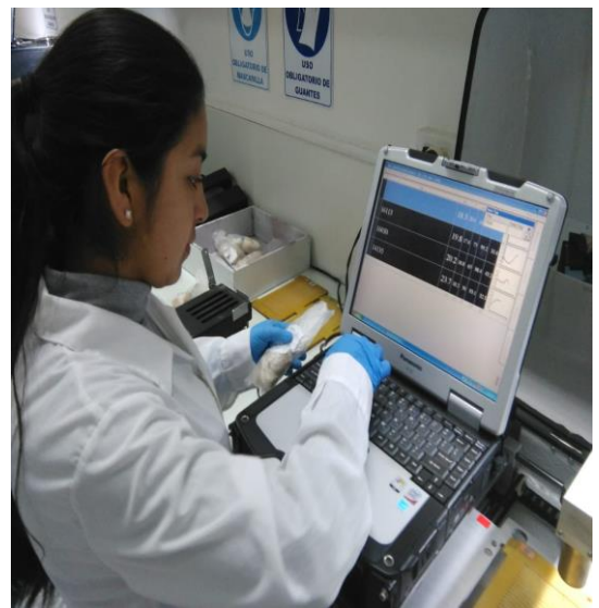
Anexo 3. Preparación de la muestra y medición en OFDA 2000
