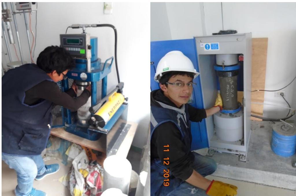
Fotografía 16. Especímenes después del ensayo a compresión
