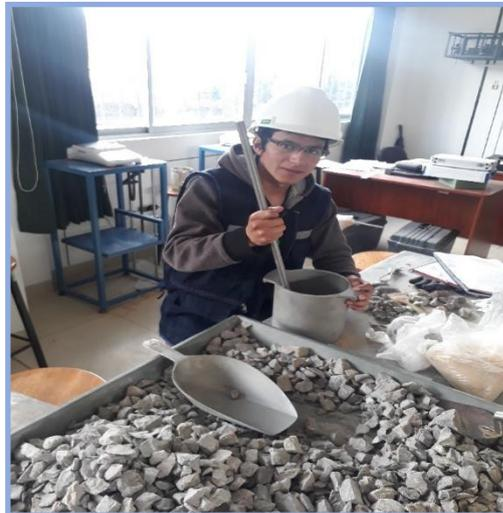
**Peso específico y absorción (NTP 400.021-400,022; ASTM C-127,128)**
