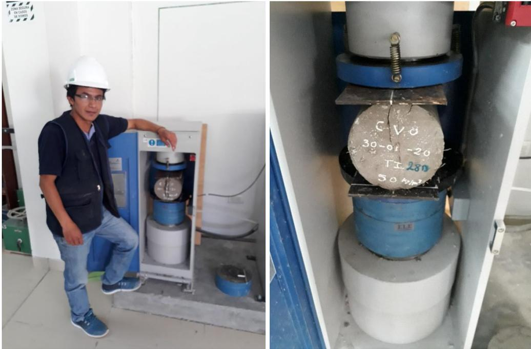
Fotografía 20. Especímenes después del ensayo a tracción
