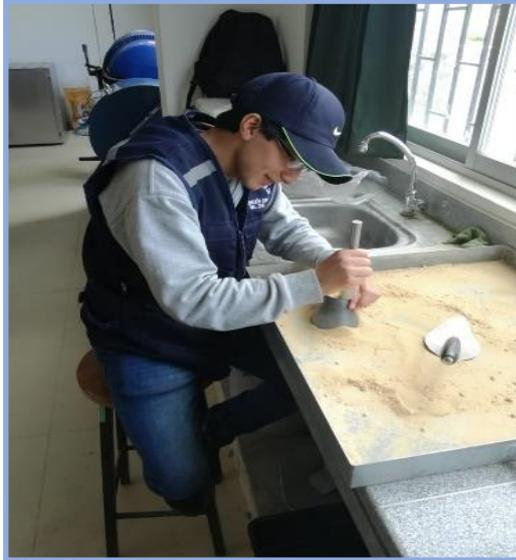
**Contenido de Humedad (NTP 339.185; ASTM C-535)**
