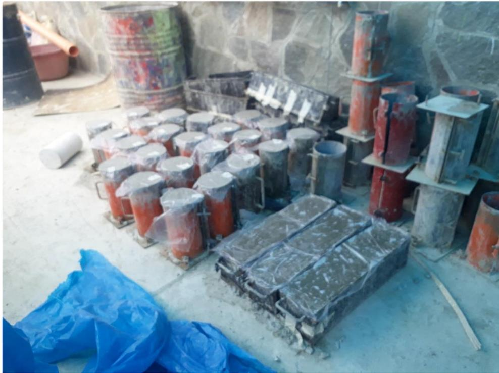
**Fotografía 14. Curado de los especímenes de concreto**
