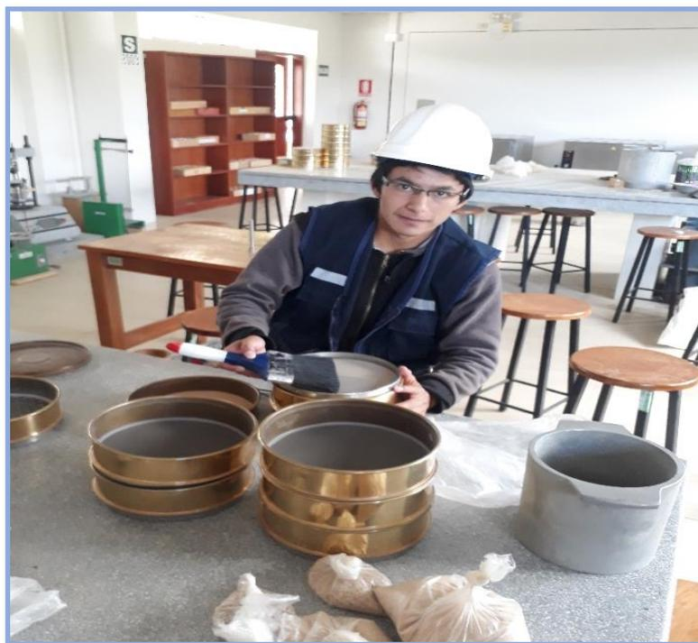
**Fotografía 7. Ensayo de peso específico del agregado fino.**
