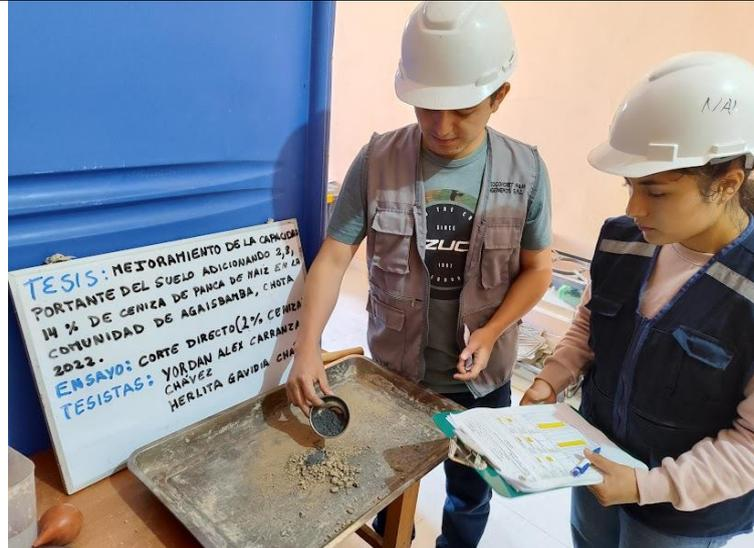
Fotografía 12: *Ensayo de corte directo, colocación de la muestra al equipo de corte directo*
