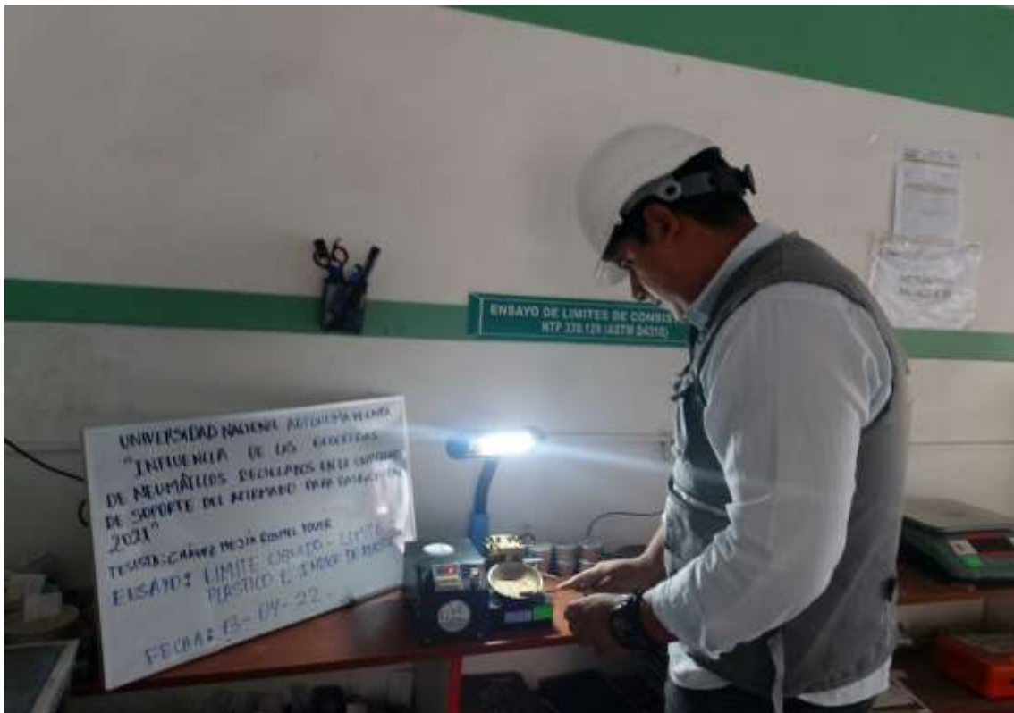
Fotografía 17. El tesista realizando el enraza de la muestra
