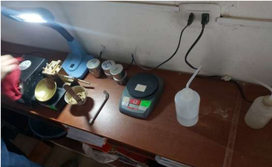
Fotografía 14. Ensayo de límite líquido - Copa de Casagrande
