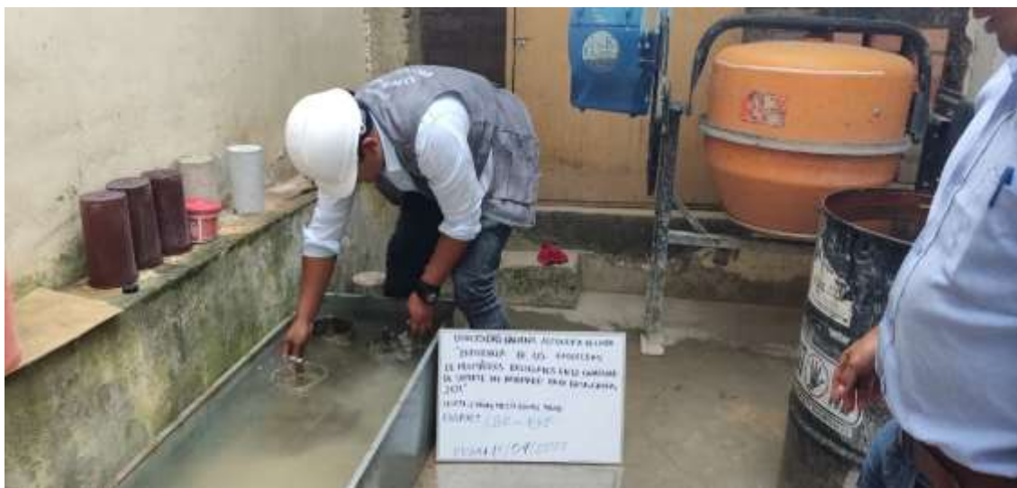
Fotografía 57. Inmersión ensayo CBR
