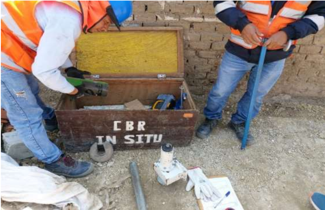
Fotografía 135. Ensayo CBR in situ geocelda circular 01
