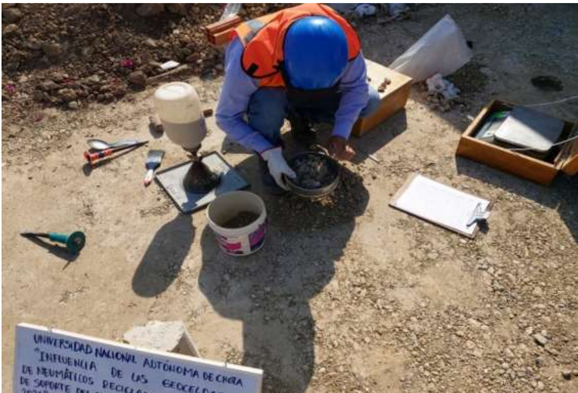
Fotografía 119. Peso retenido en el tamiz \frac{3}{4} "
