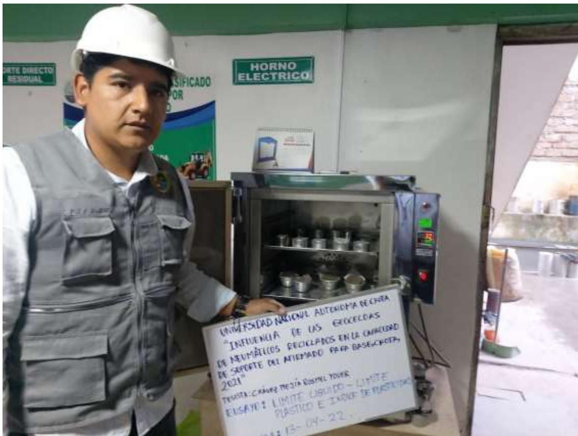
Fotografía 39. Muestras húmedas en el horno para ser secadas
