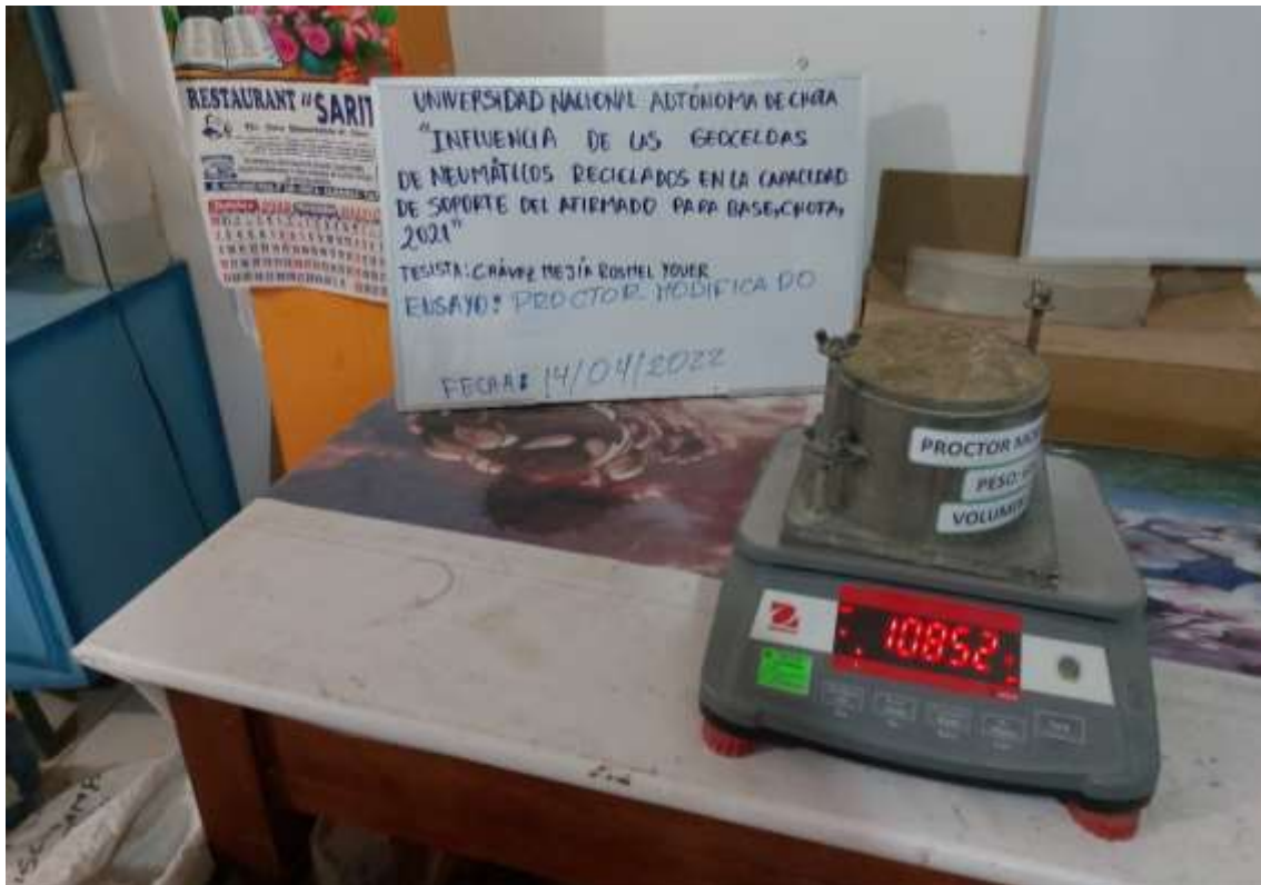
Fotografía 48. Peso volumétrico húmedo molde 01
