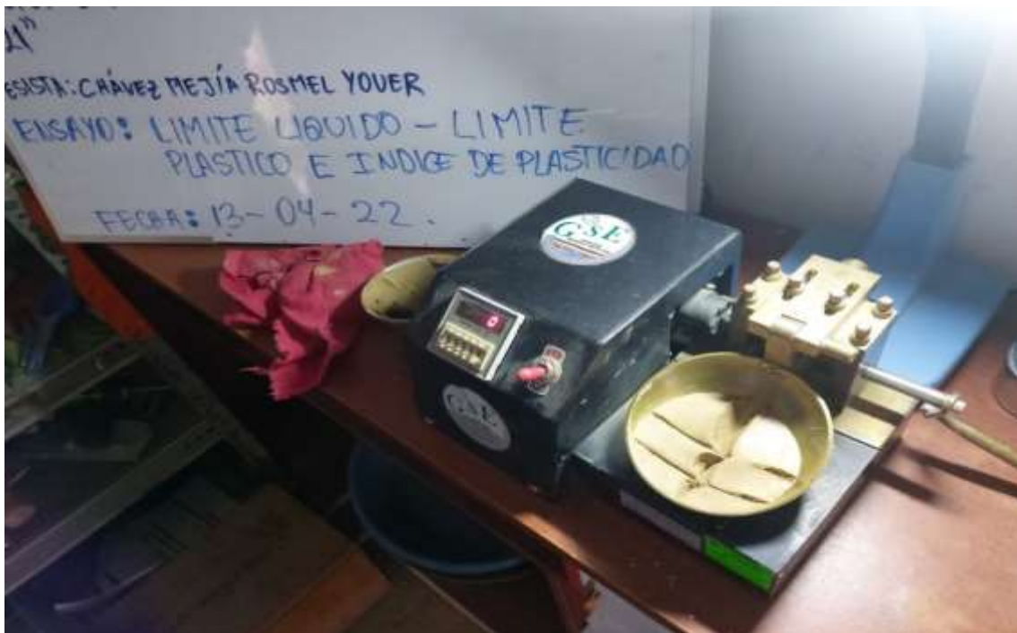
Fotografía 22. Muestra cerrada en la Copa de Casagrande
