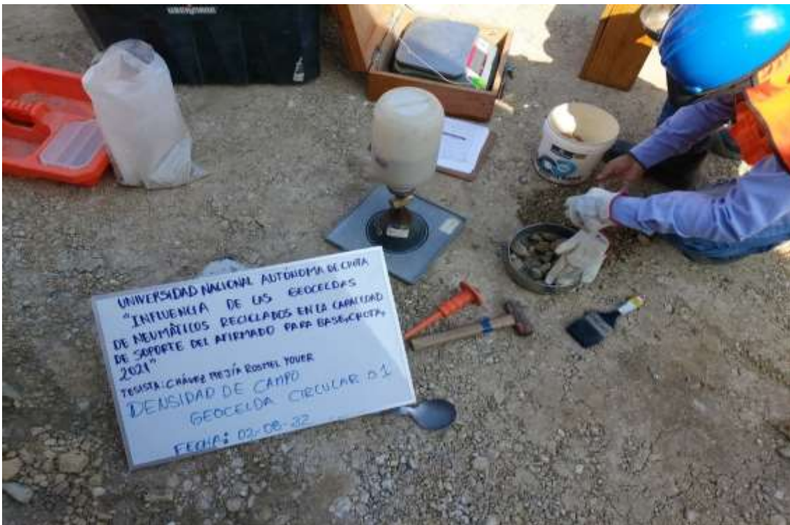
Fotografía 121. Vertido de arena de Ottawa geocelda circular 01
