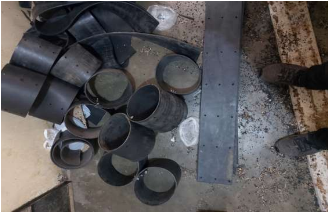
Fotografía 70. Confección de geoceldas
