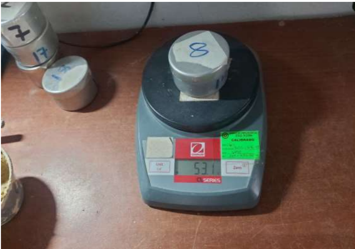
Fotografía 25. Peso de tara 08 + muestra húmeda, Segunda muestra
