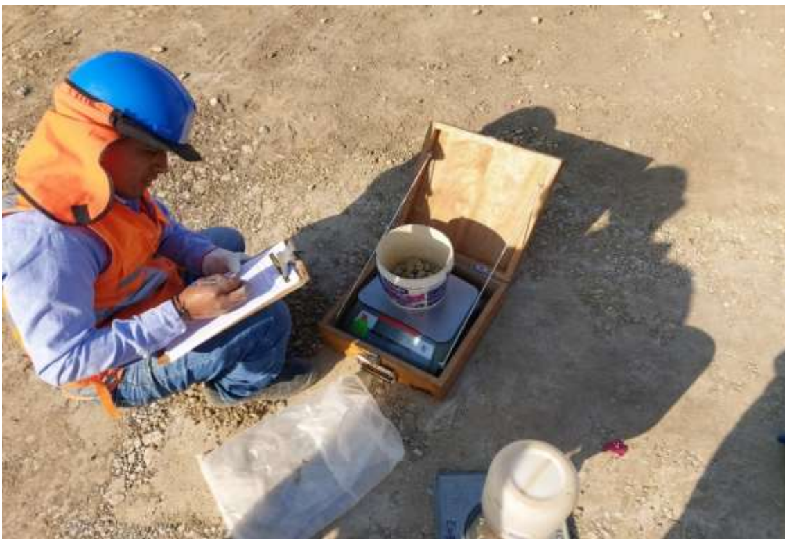
Fotografía 132. Peso retenido en el tamiz 3/4"
