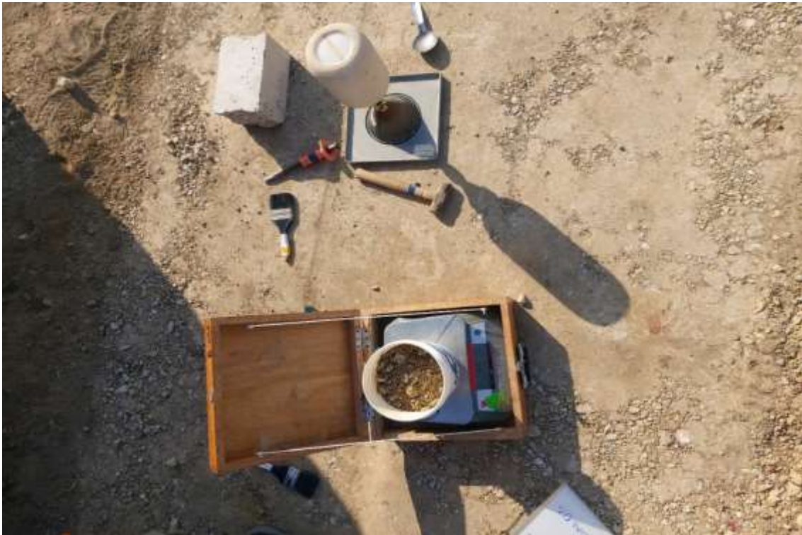
Fotografía 129. Peso de material extraído y vertido de arena de Ottawa
