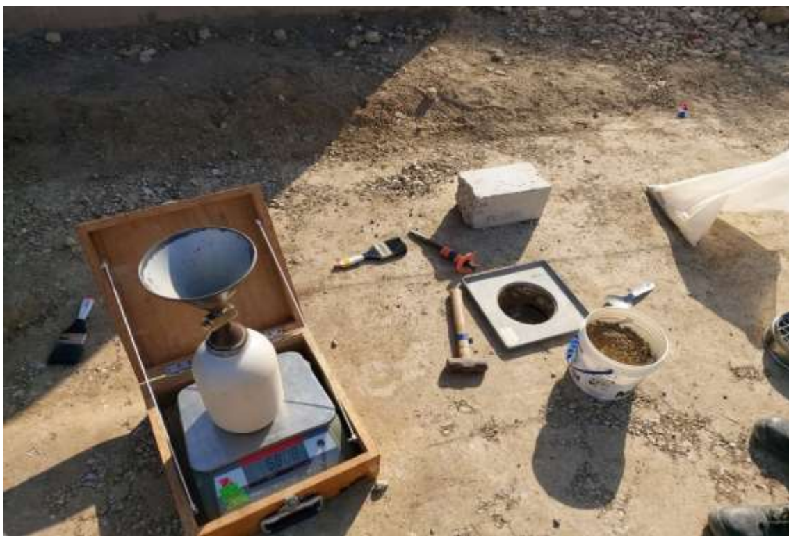
Fotografía 128. Peso de cono de arena y arena de Ottawa
