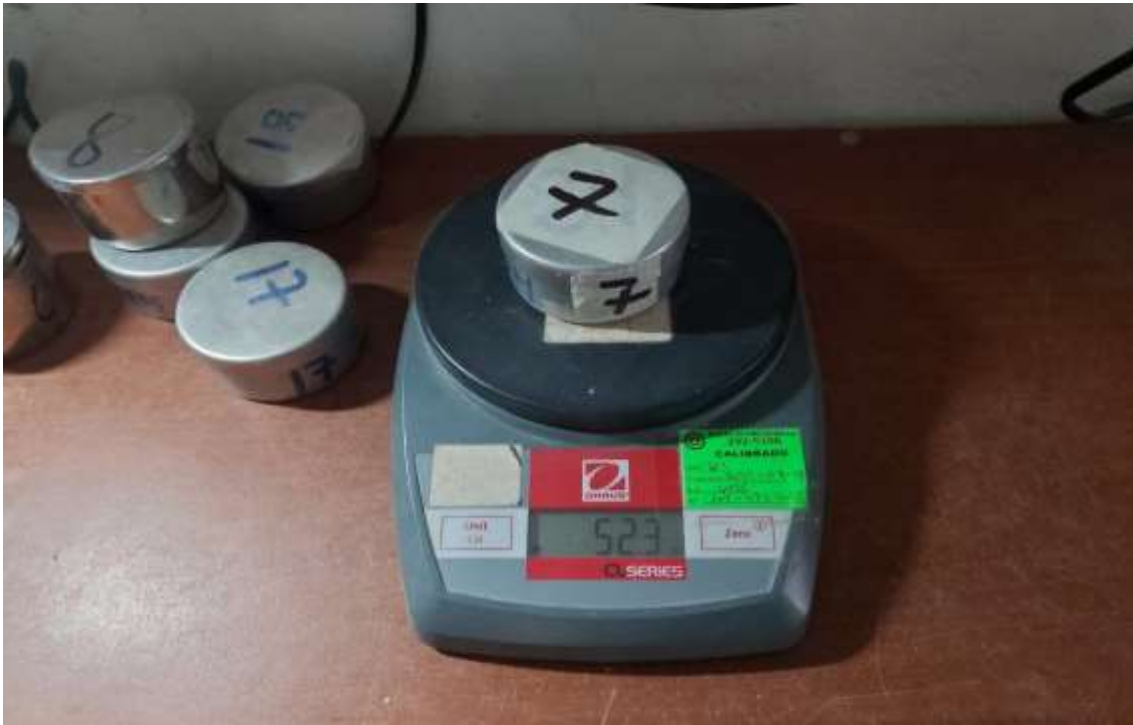
Fotografía 24. Peso de tara 07 + muestra húmeda, primera muestra
