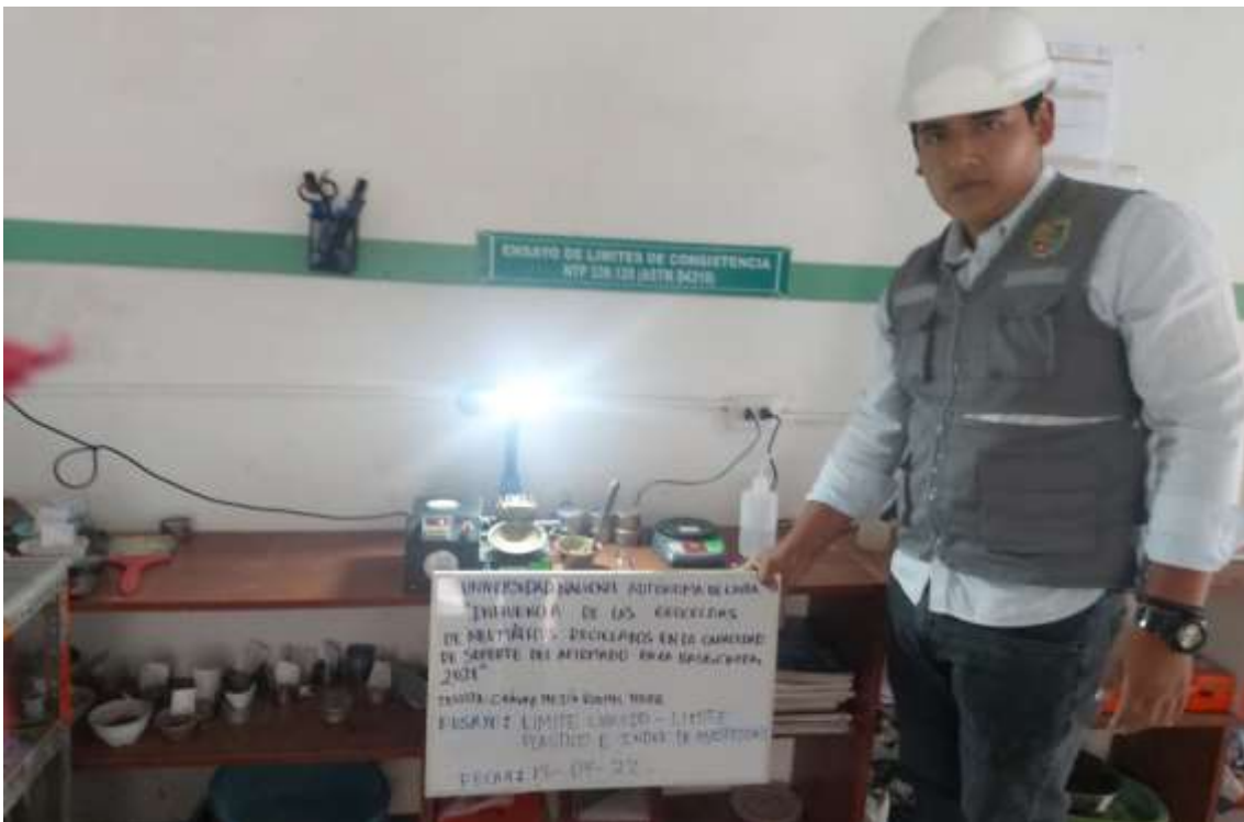
Fotografía 15. Ensayo de límite líquido.
