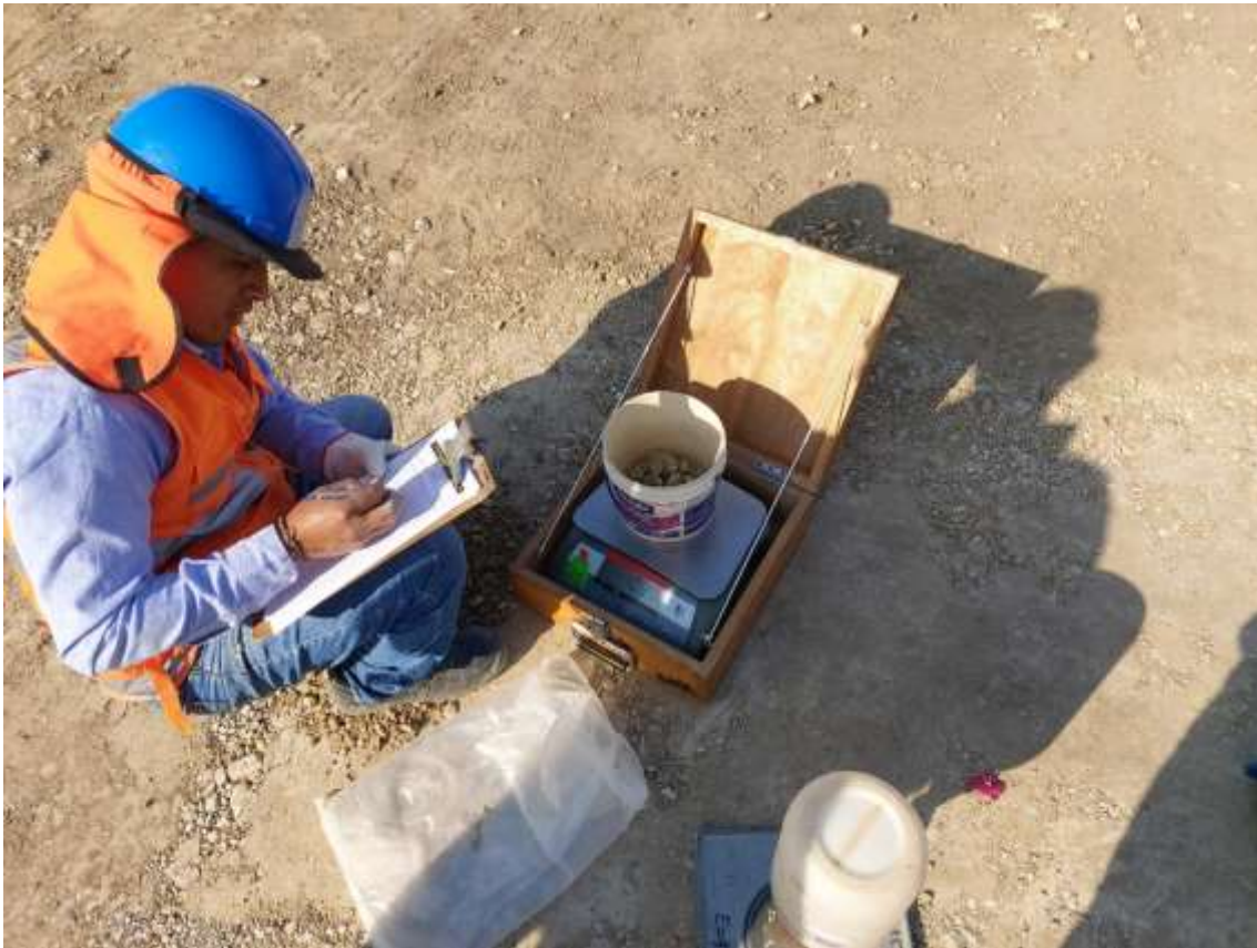
Fotografía 133. Peso retenido en el tamiz \frac{3}{4} "
