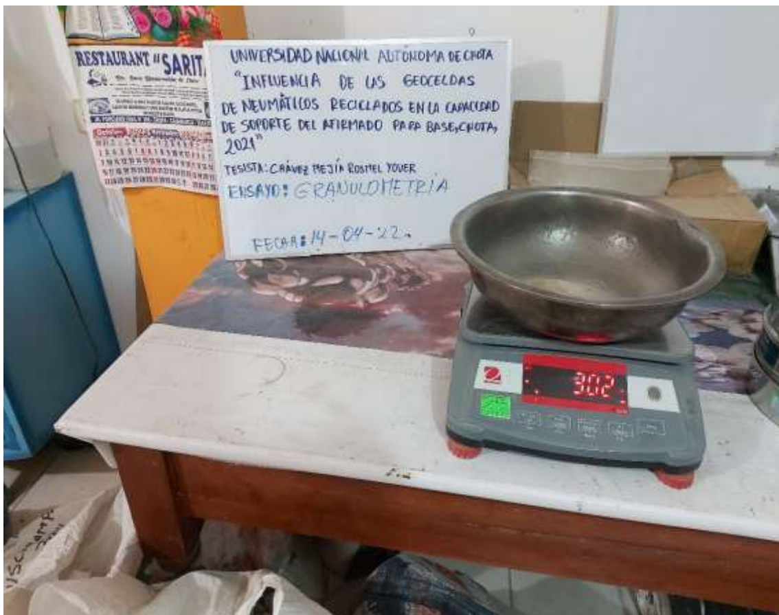
Fotografía 12. Peso retenido en el tamiz No. 10
