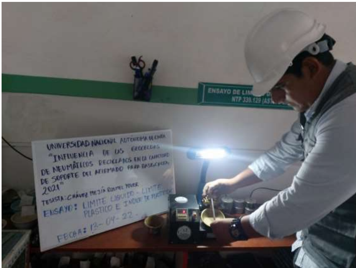
Fotografía 19. Muestra en la Copa de Casagrande
