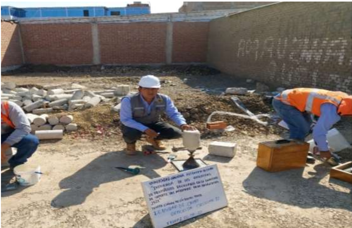
Fotografía 122. El tesista vertiendo a arena de Ottawa en el prototipo de a geocelda 02
