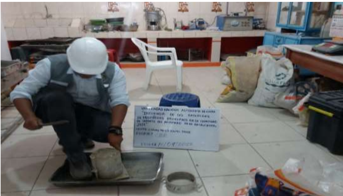
Fotografía 51. Elaboración de especímenes
