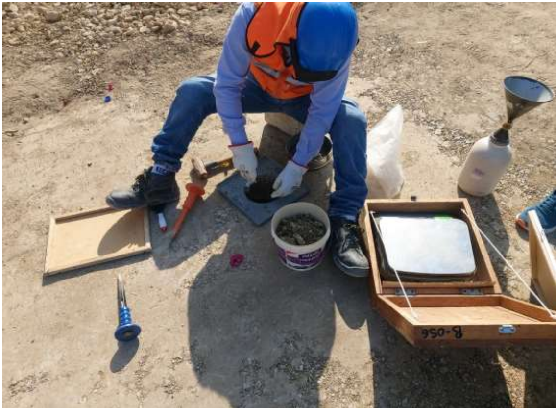
Fotografía 128. Peso de cono de arena y arena de Ottawa
