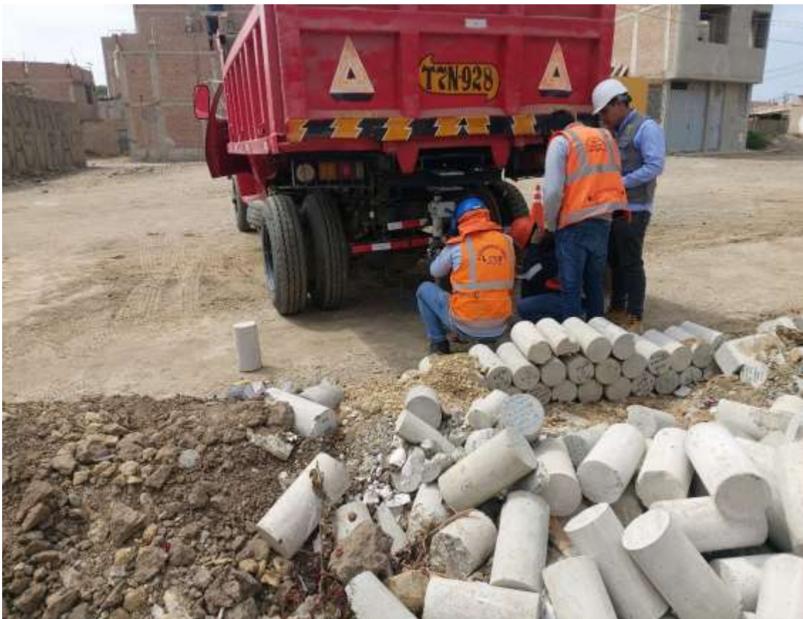
Fotografía 142. Aplicación de la carga al pistón de penetración
