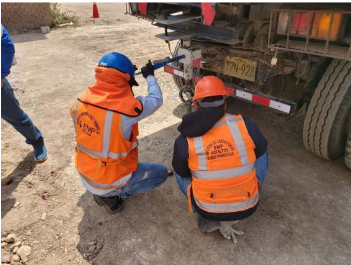
Fotografía 145. Aplicación de la carga al pistón de penetración
