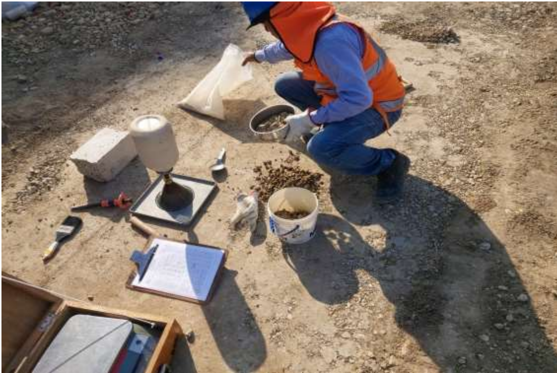
Fotografía 131. Peso retenido en el tamiz 3/4"
