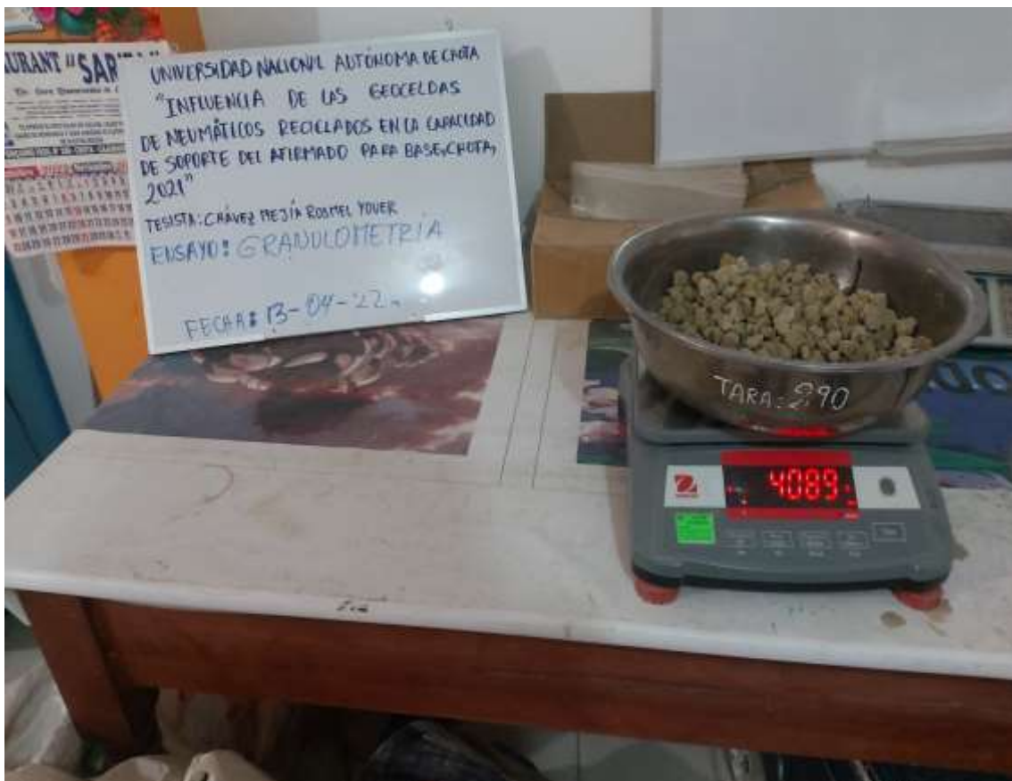
Fotografía 6. Peso retenido en el tamiz 1/2”
