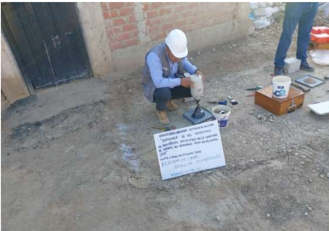
Fotografía 130. Peso de material extraído y vertido de arena de Ottawa
