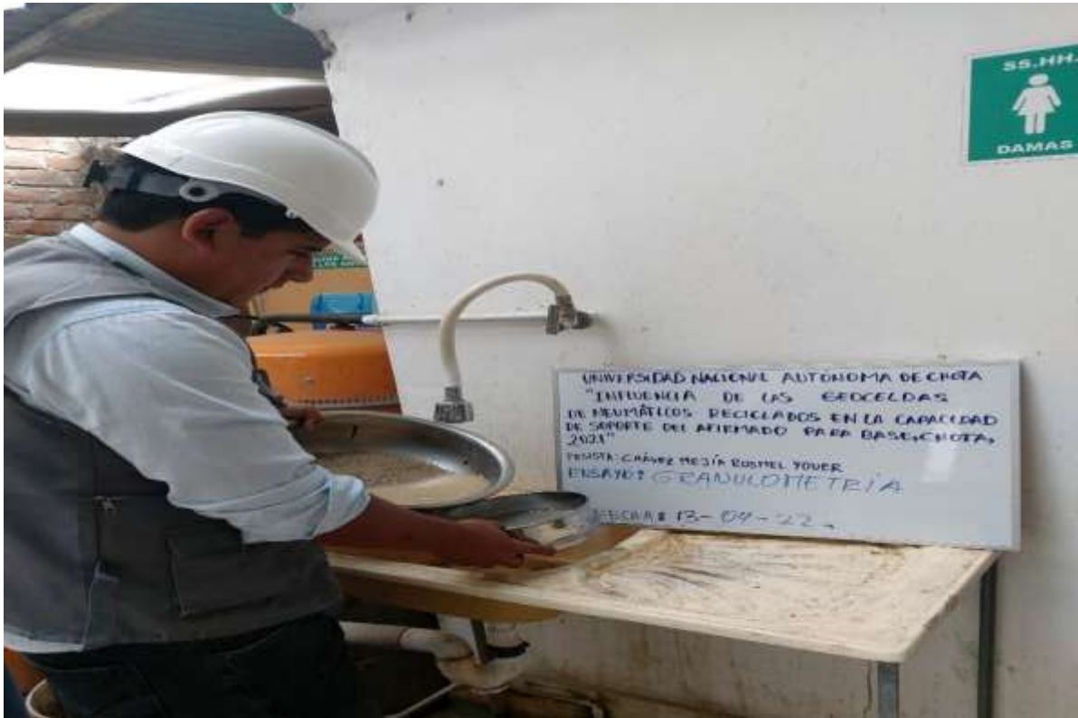
Fotografía 10. Análisis granulométrico de la fracción fina.
