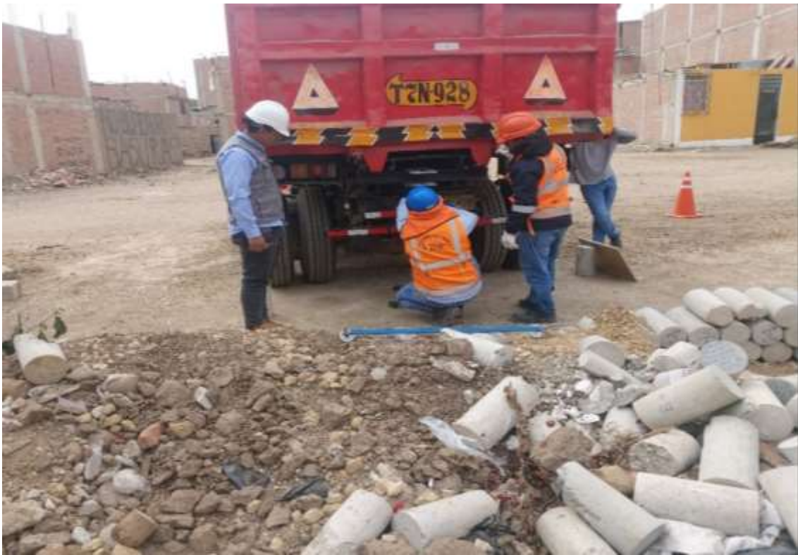
Fotografía 138. Adición de pesos de sobrecarga
