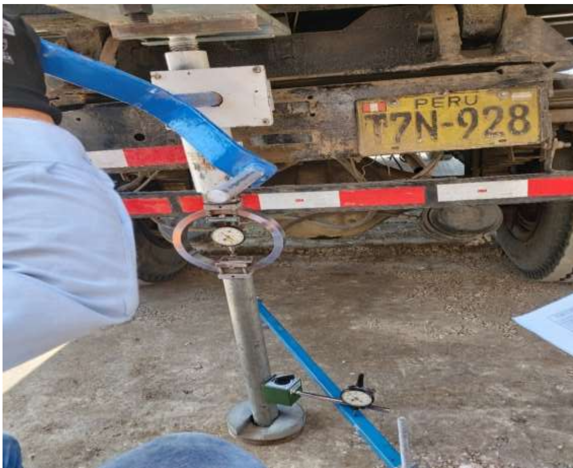
Fotografía 149. Aplicación de la carga al pistón de penetración
