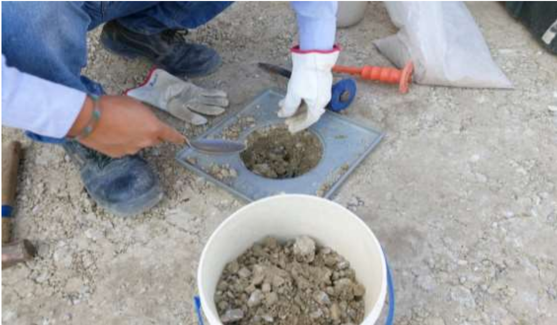
Fotografía 115. Perforación (cavado con cincel)
