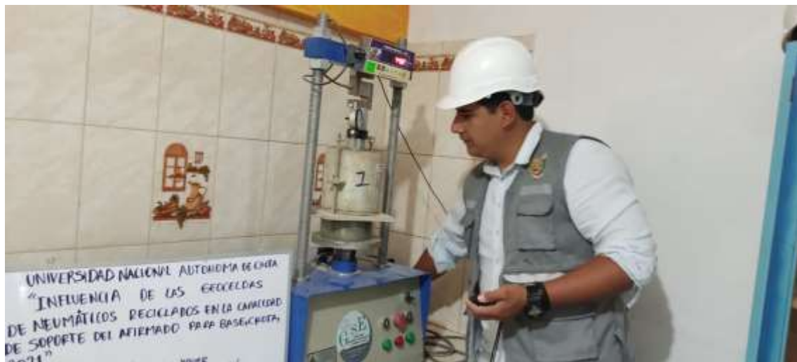
Fotografía 60. Penetración ensayo CBR
