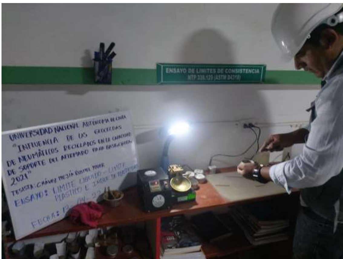
Fotografía 35. El tesista extrayendo la muestra para límite plástico
