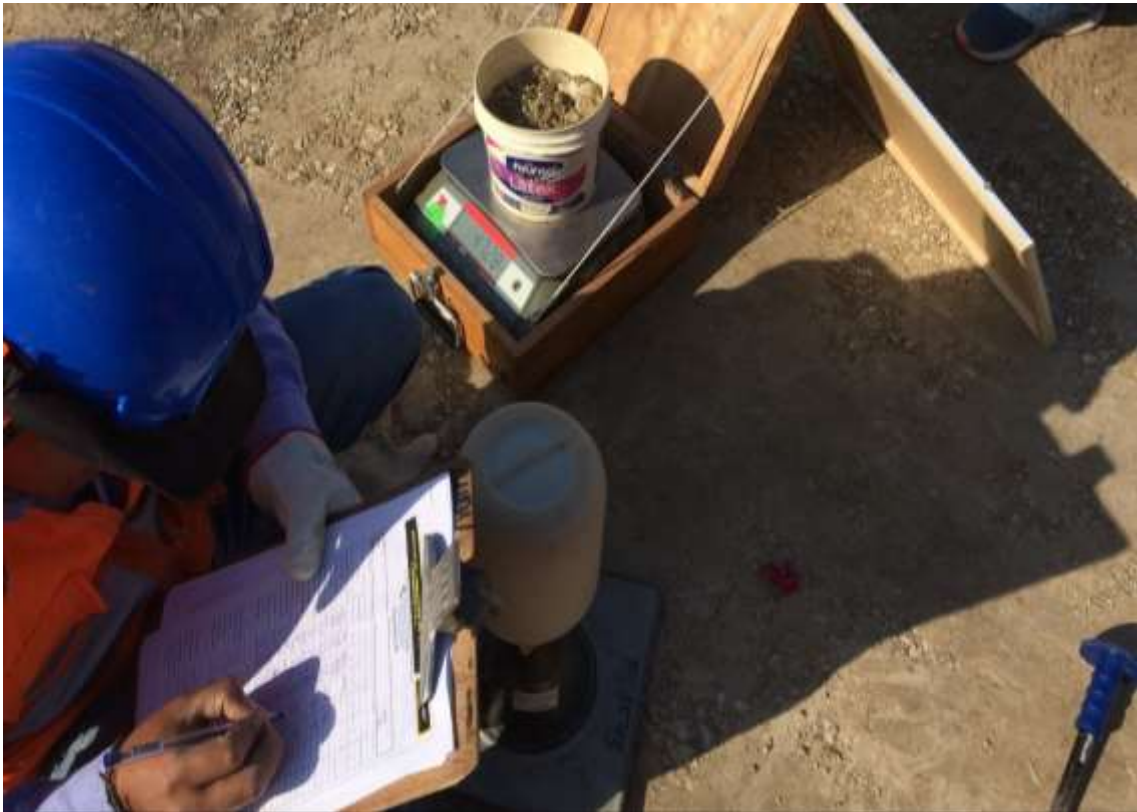
Fotografía 117. Peso de material extraído
