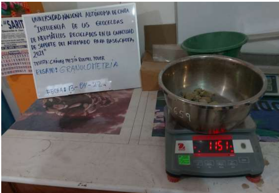
Fotografía 6. Peso retenido en el tamiz 1/2”
