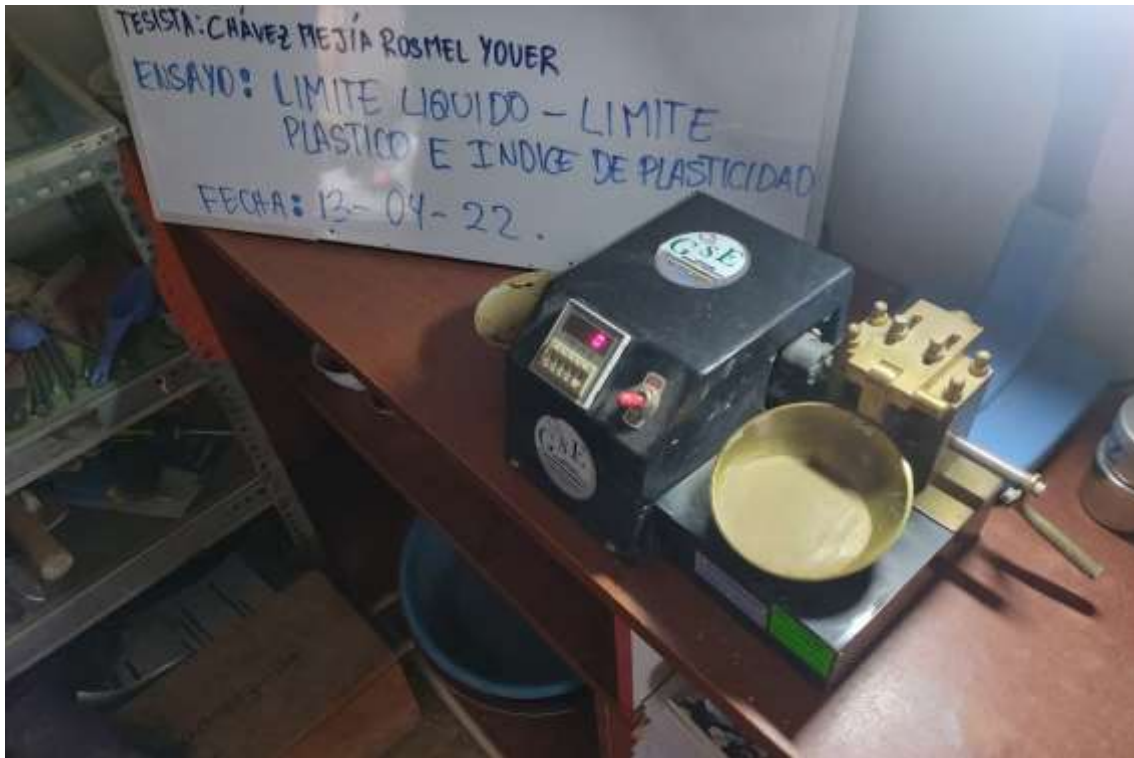
Fotografía 19. Muestra en la Copa de Casagrande
