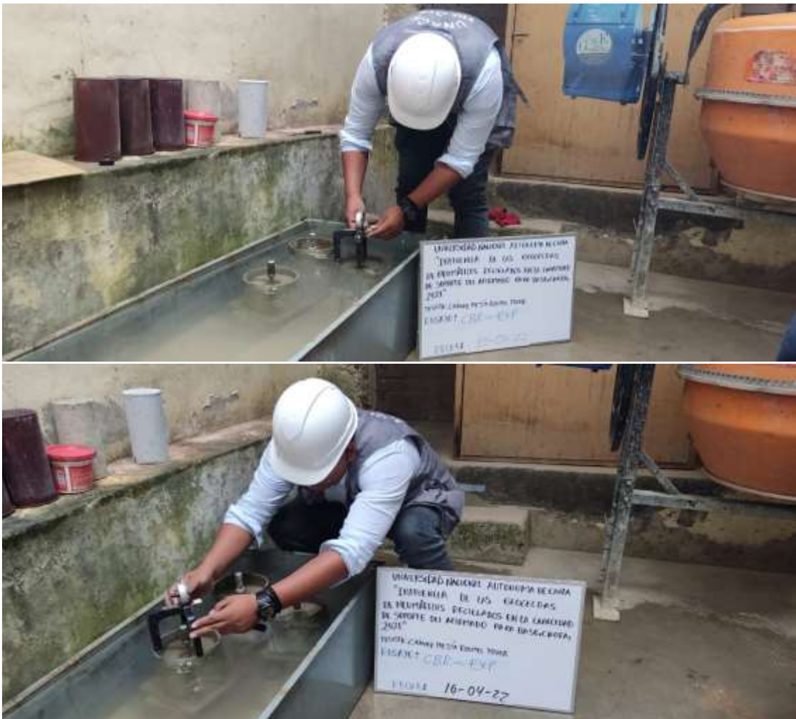
Fotografía 59. inmersión ensayo CBR
