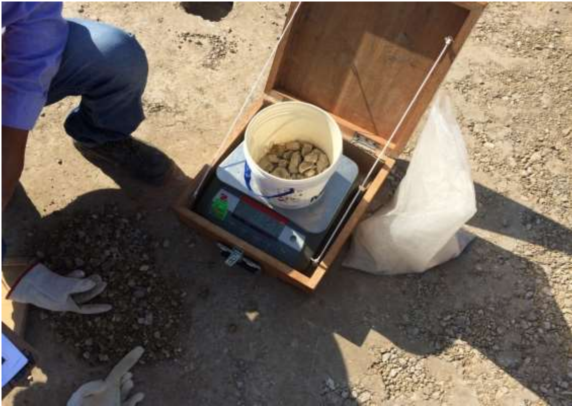
Fotografía 121. Vertido de arena de Ottawa geocelda circular 01
