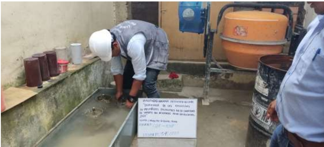
Fotografía 59. inmersión ensayo CBR
