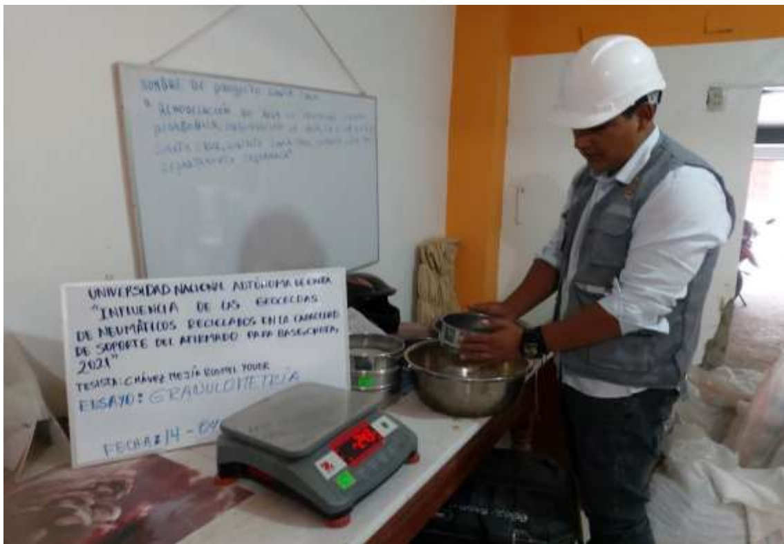
Fotografía 12. Peso retenido en el tamiz No. 10
