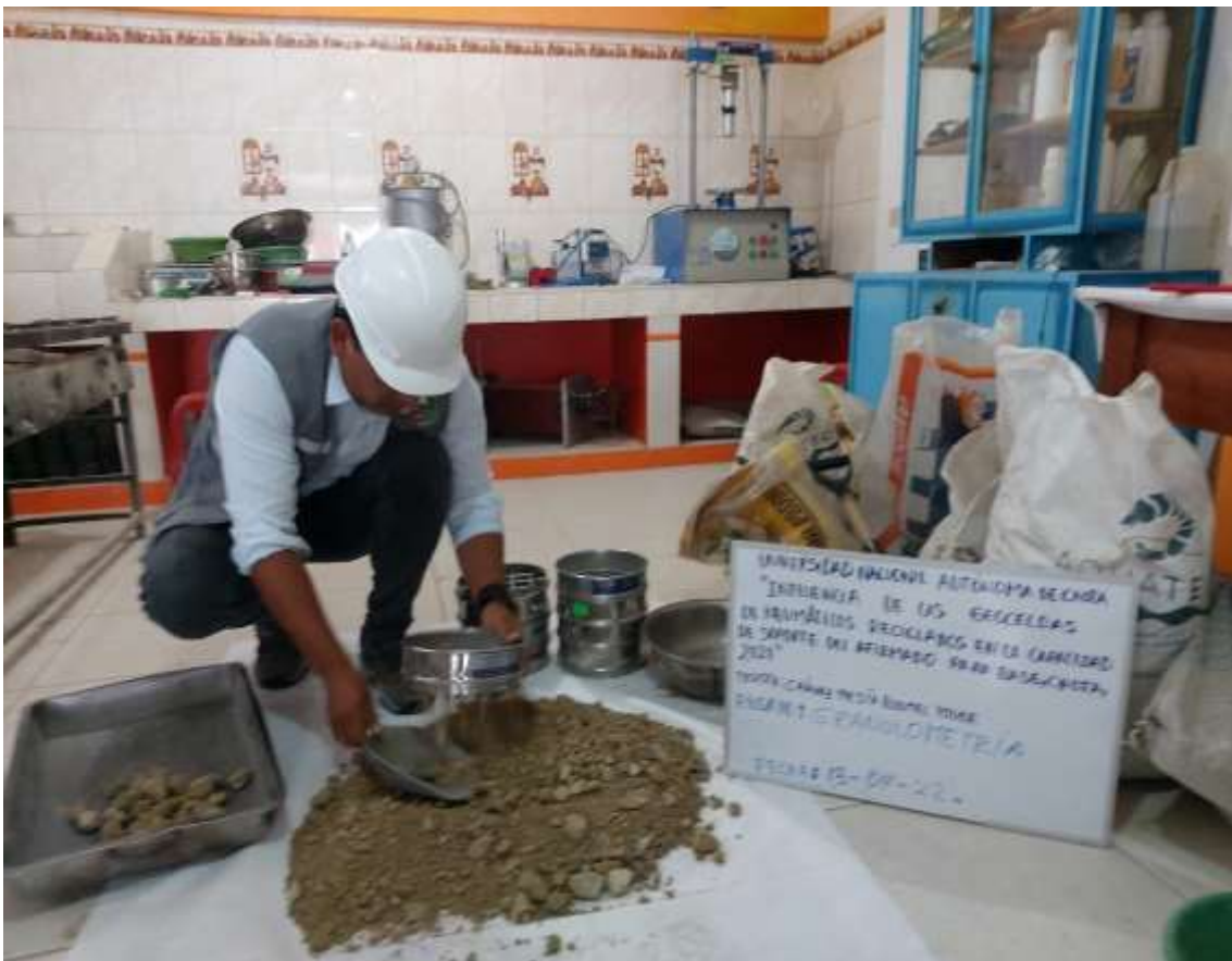
Fotografía 4. El tesista realizando el ensayo de granulometría
