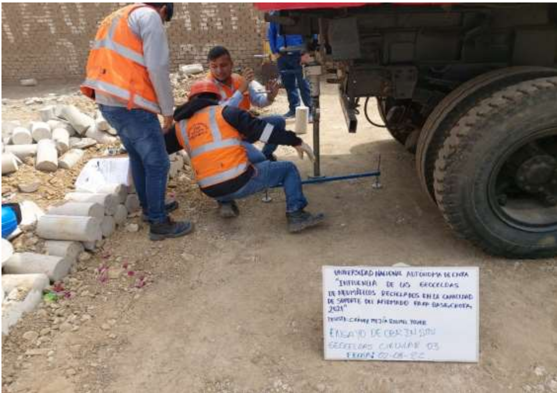
Fotografía 142. Aplicación de la carga al pistón de penetración
