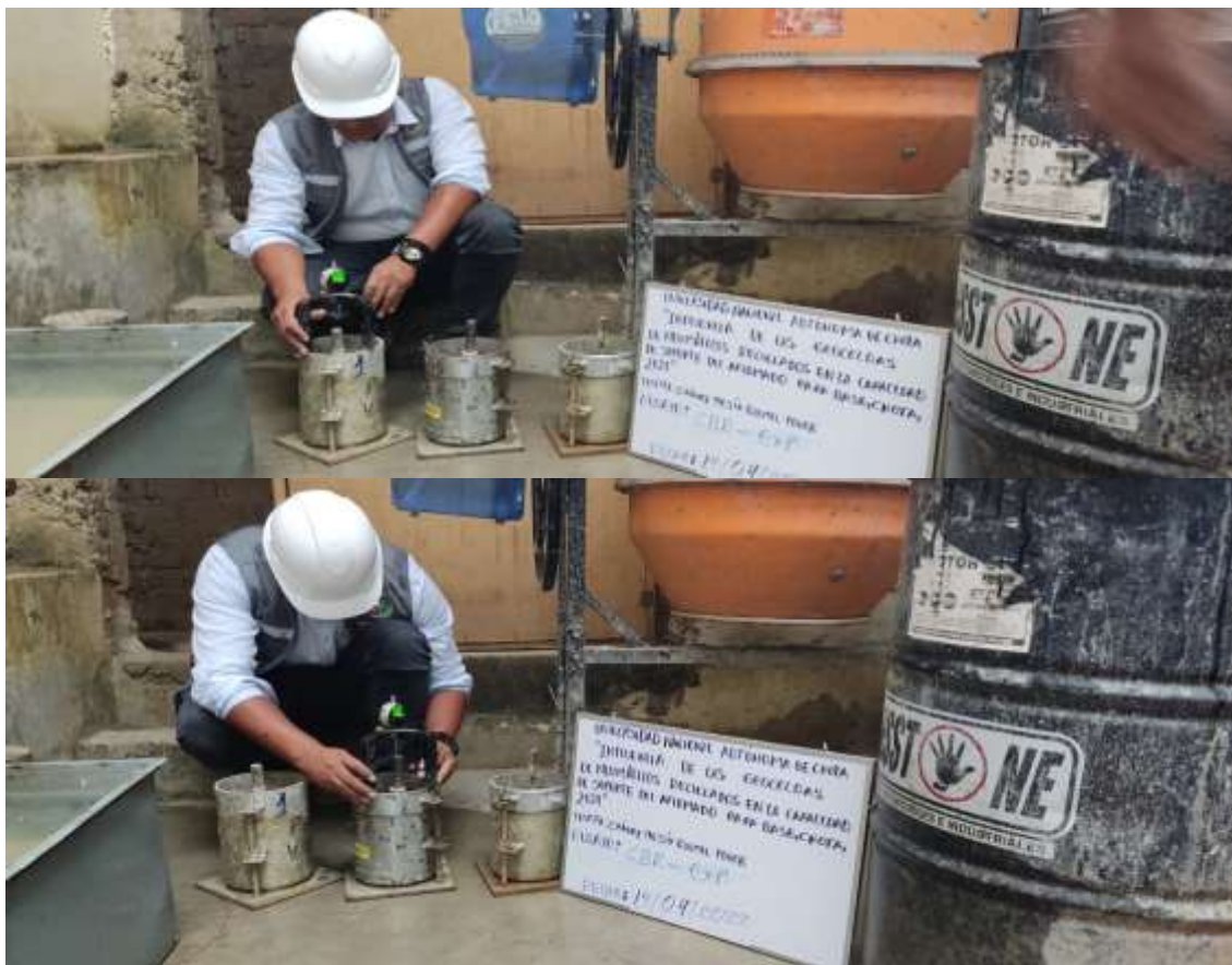
Fotografía 56. Inmersión ensayo CBR
