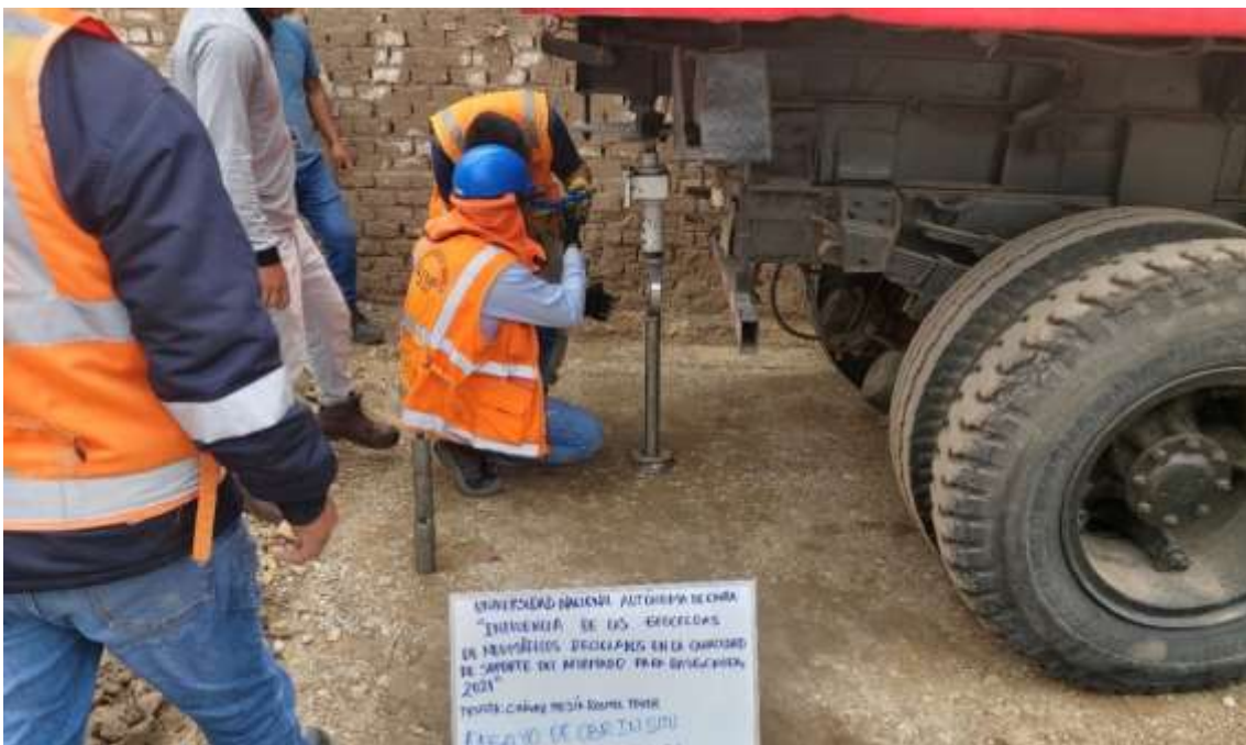
Fotografía 135. Ensayo CBR in situ geocelda circular 01
