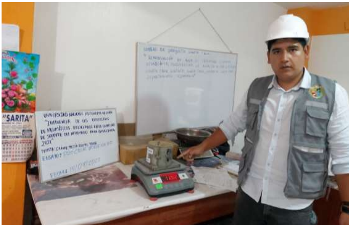
Fotografía 49. Peso volumétrico húmedo molde 03
