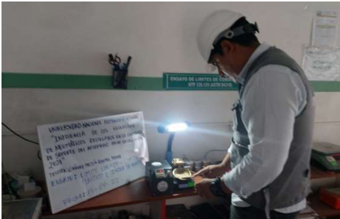
Fotografía 16. El tesista realizando el ensayo de límite líquido.
