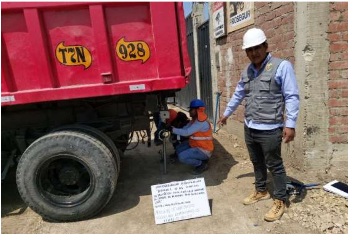
Fotografía 149. Aplicación de la carga al pistón de penetración
