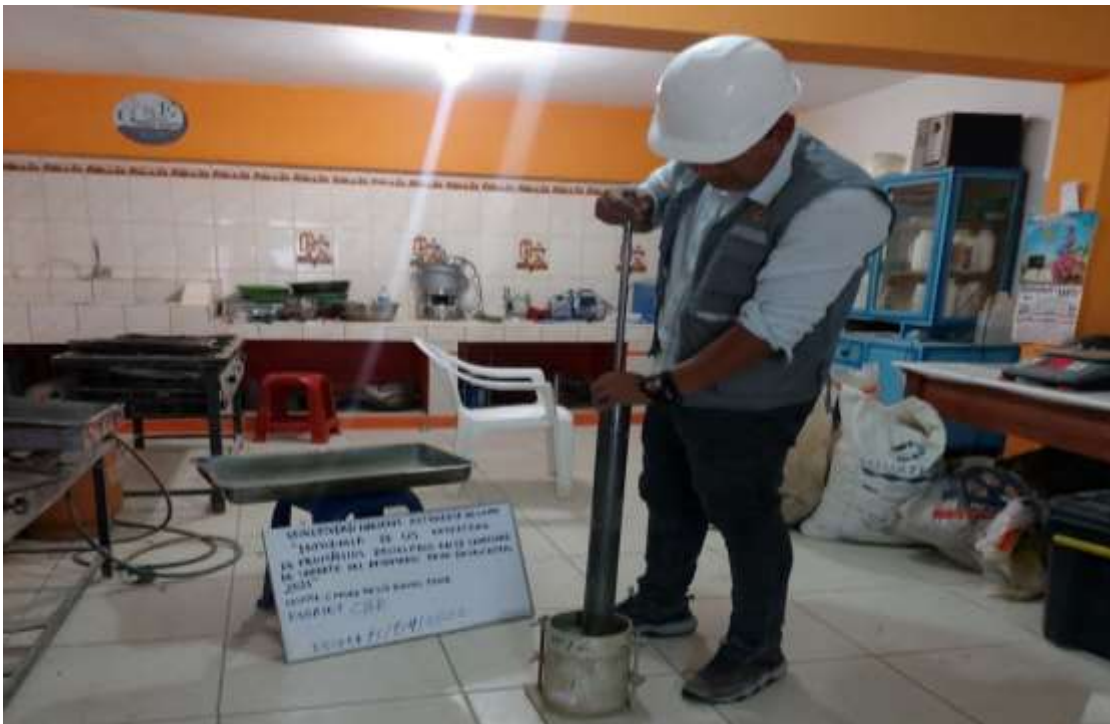
Fotografía 50. Elaboración de especímenes
