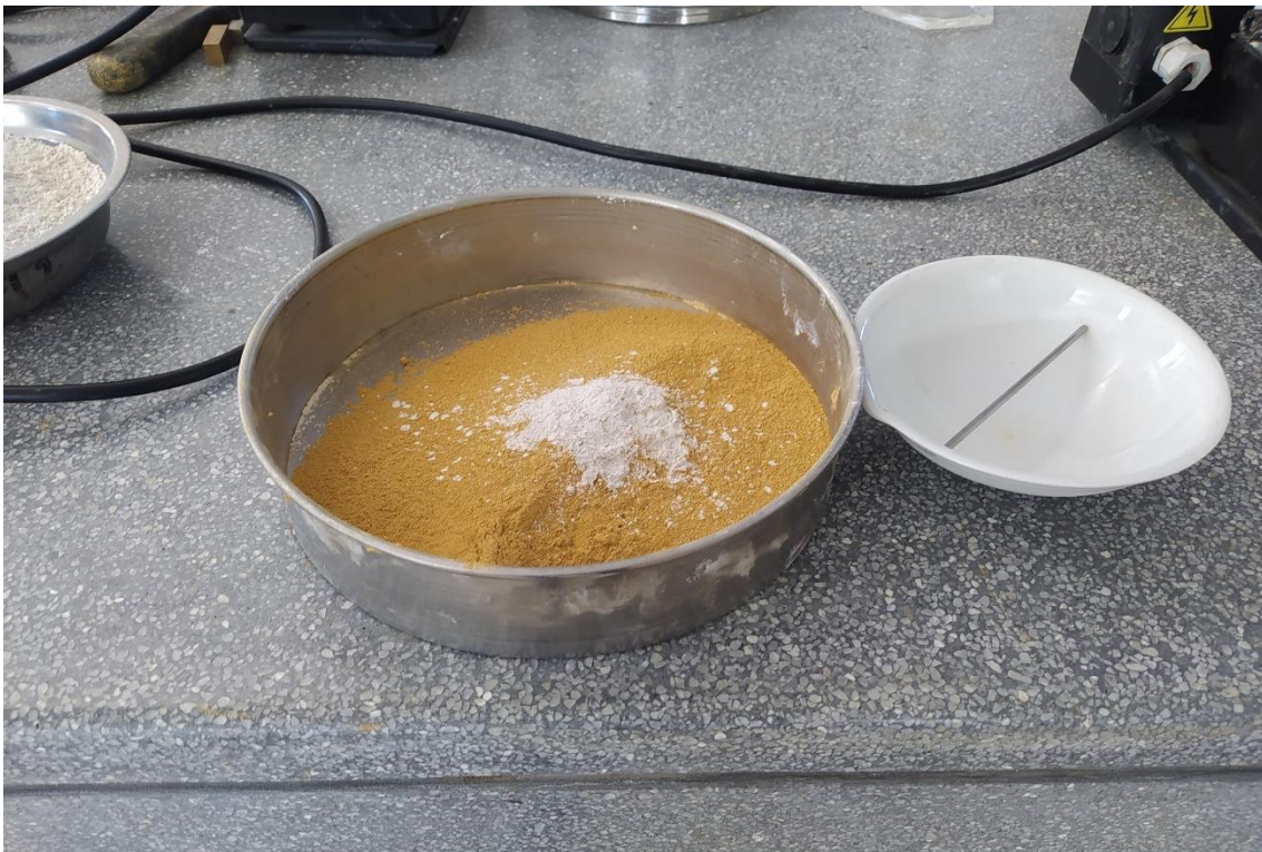
Fotografía 12. Límites de consistencia del suelo con residuos de cal
