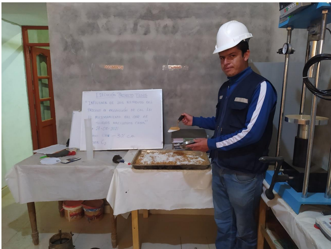
Fotografía 16. Preparación del suelo con residuos de cal para ensayo de CBR
