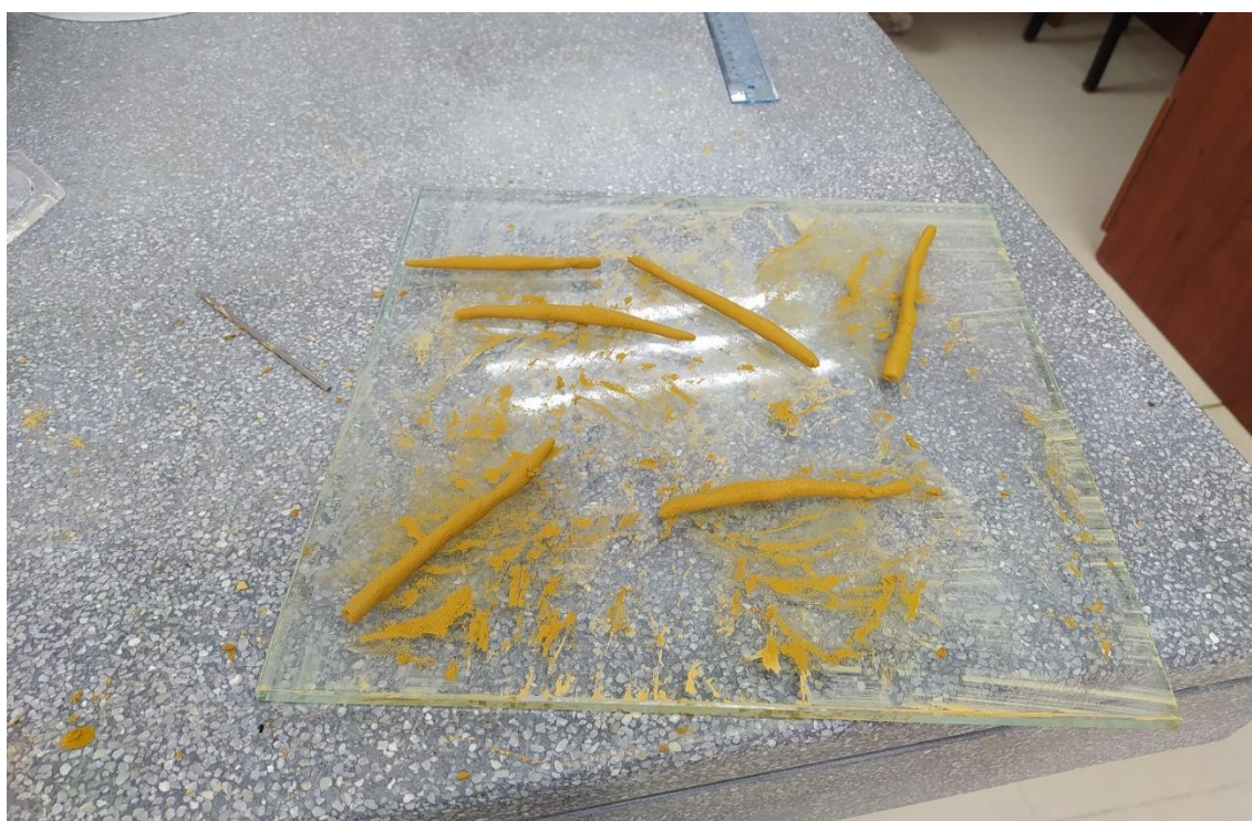
Fotografía 10. Límite plástico del suelo natural
