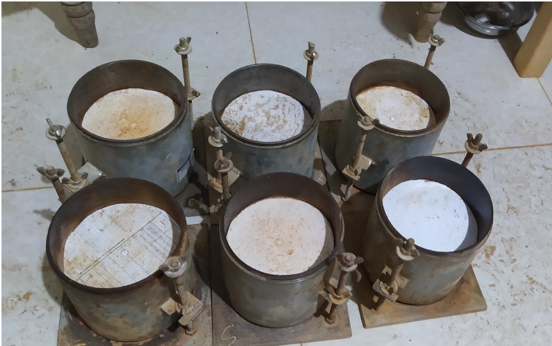
Fotografía 17. Probetas para ensayo CBR
