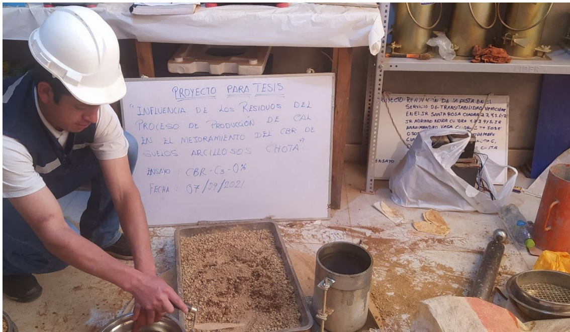
Fotografía 15. Preparación del suelo natural para ensayo de CBR
