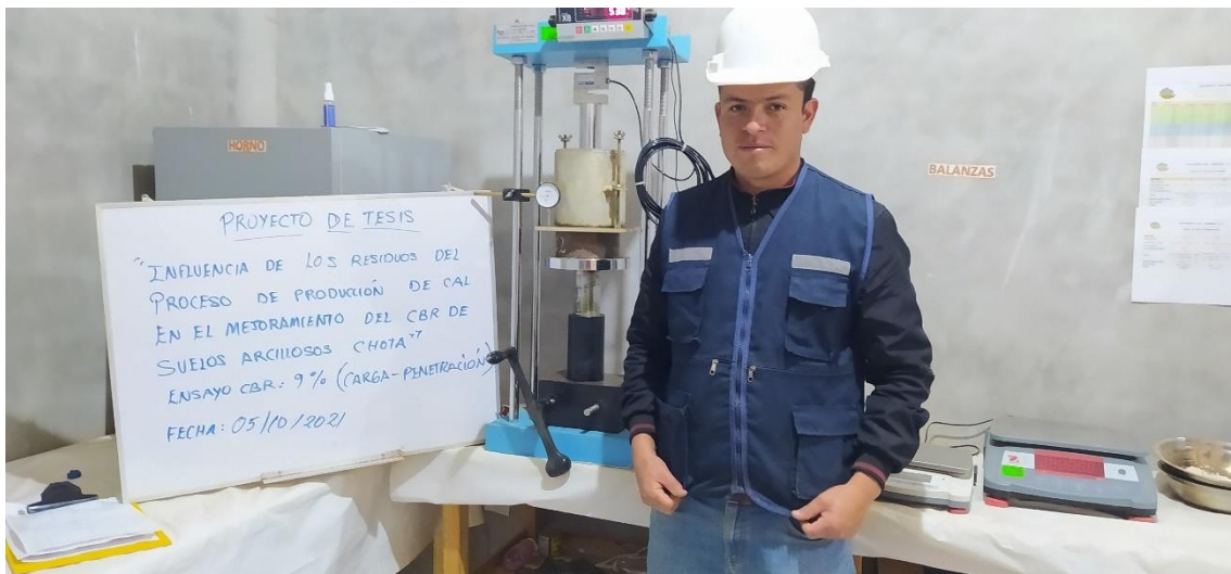
Fotografía 19. Ensayo de CBR
