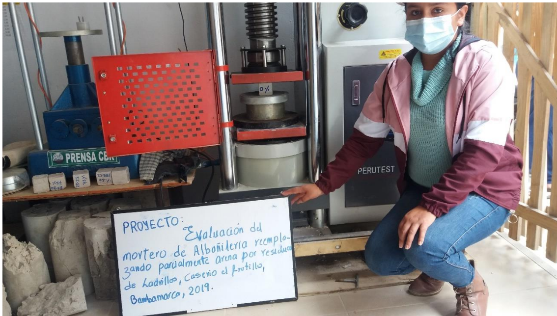
Fotografía 9. Ensayo de resistencia a compresión en cubos de mortero, con 0% de residuos de ladrillo
