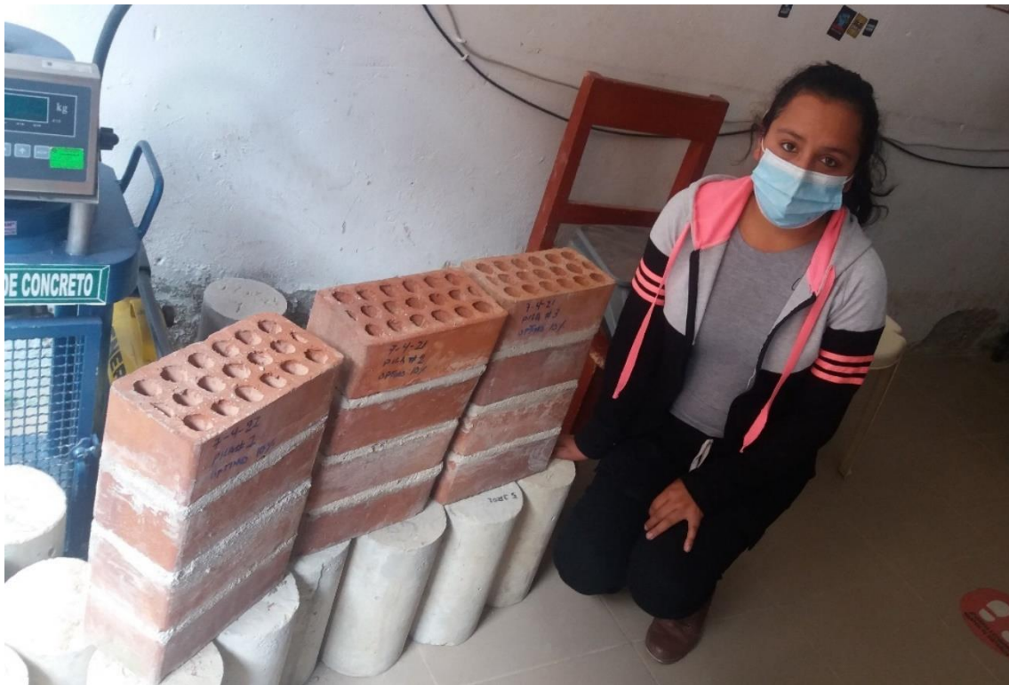
Fotografía 15. Elaboración de pilas de albañilería con mortero con residuos de ladrillo
