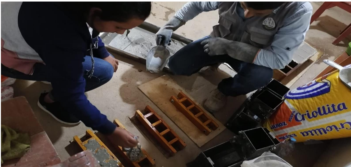
Fotografía 7. Elaboración de los cubos de mortero
