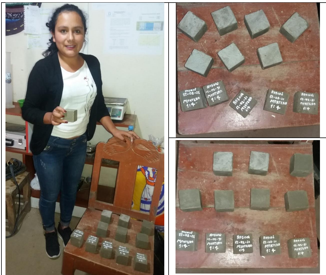
Fotografía 8. Cubos de mortero
