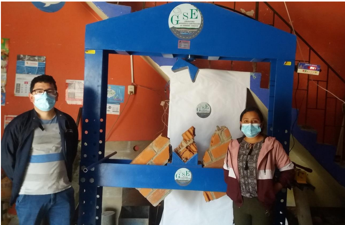
Fotografía 20. Rotura de muretes
