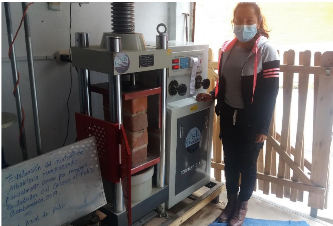
Fotografía 16. Ensayo de resistencia a compresión axial en pilas
