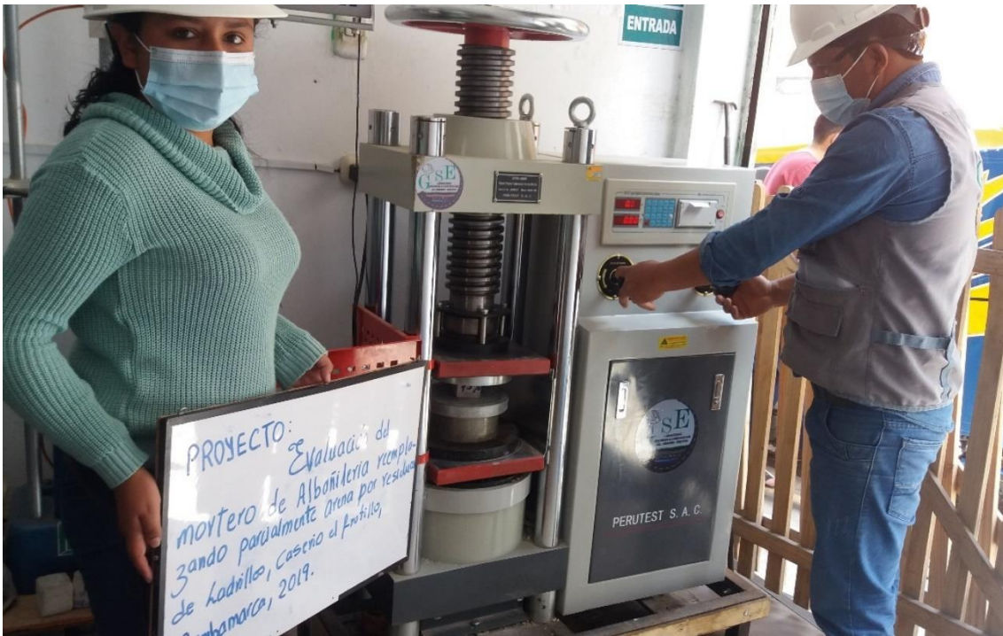
Nota: Colocación del cubo de mortero con 75% de residuos de ladrillo, en la máquina de compresión.
