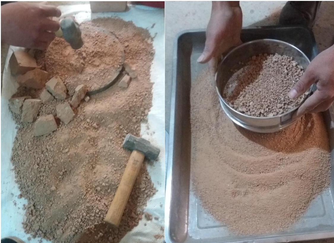
Fotografía 3. Tamizado de los residuos de ladrillo
