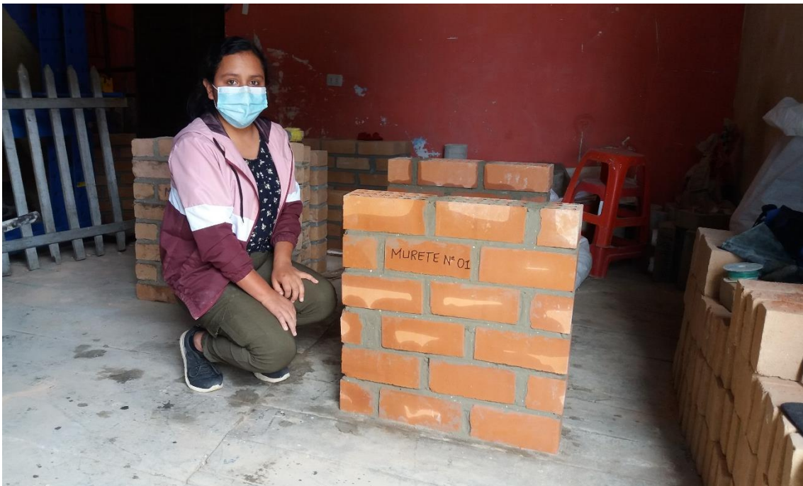
Fotografía 18. Muretes de albañilería
