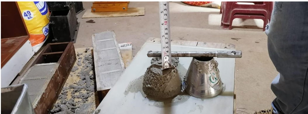
Fotografía 5. Comprobación de la trabajabilidad de la mezcla de mortero
