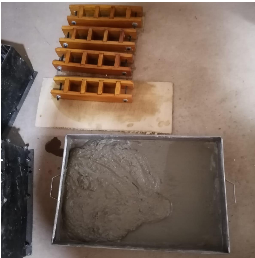
Fotografía 6. Molde y mezcla para la elaboración de los cubos de mortero
