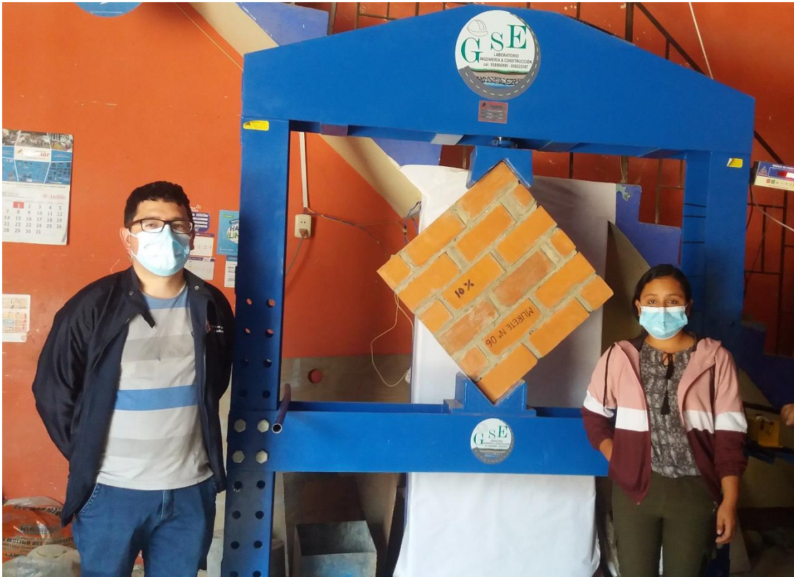
Fotografía 19. Ensayo de corte diagonal en muretes
