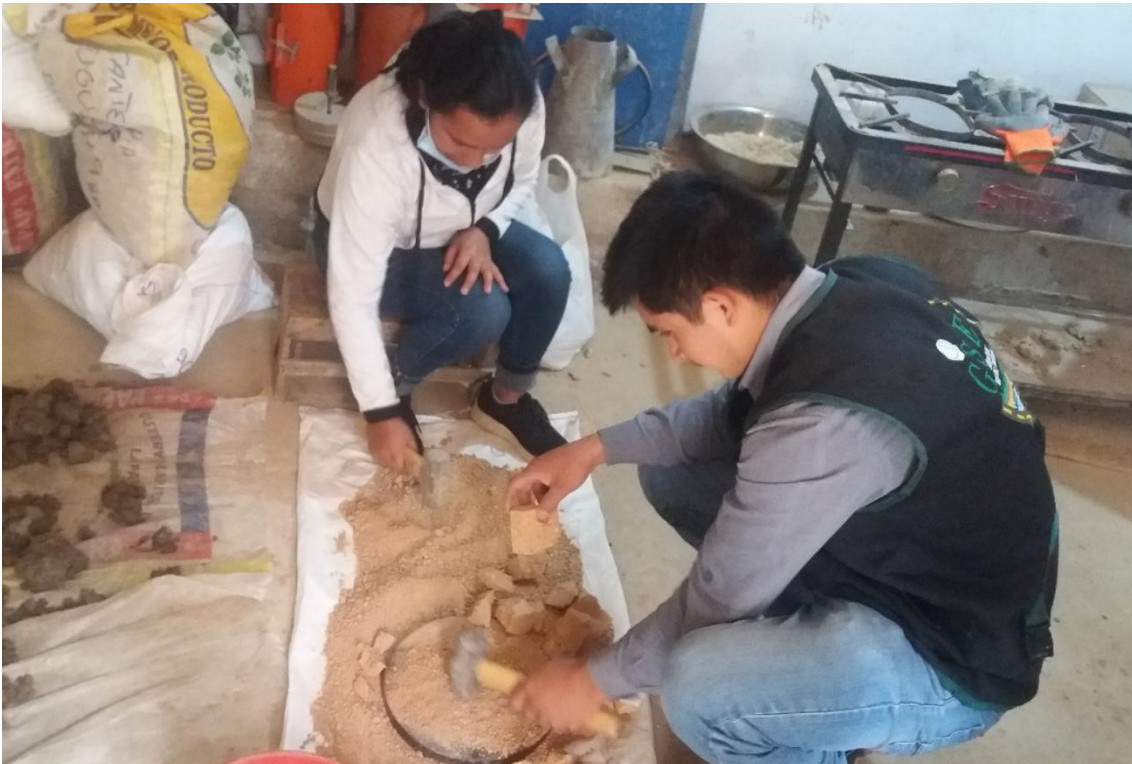
Fotografía 2. Trituración manual de residuos de ladrillo
