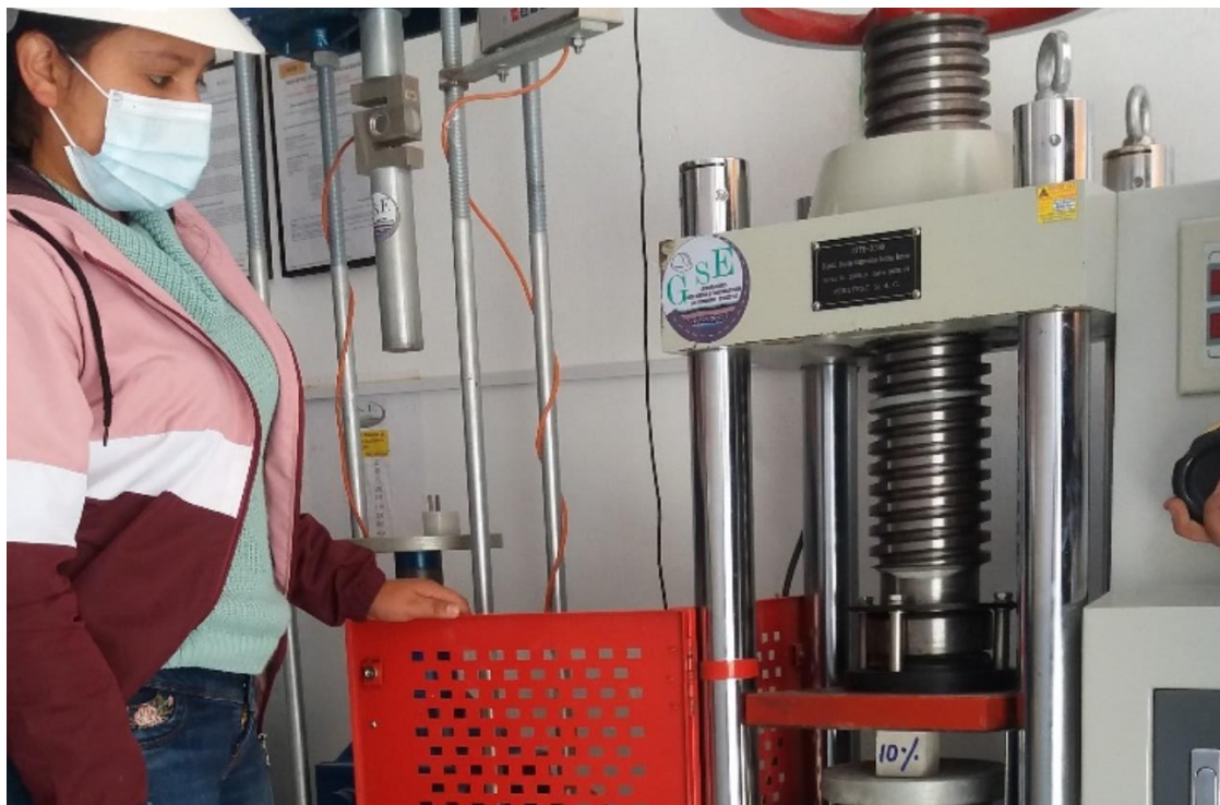
Fotografía 10. Ensayo de resistencia a compresión en cubos de mortero, con 10% de residuos de ladrillo
