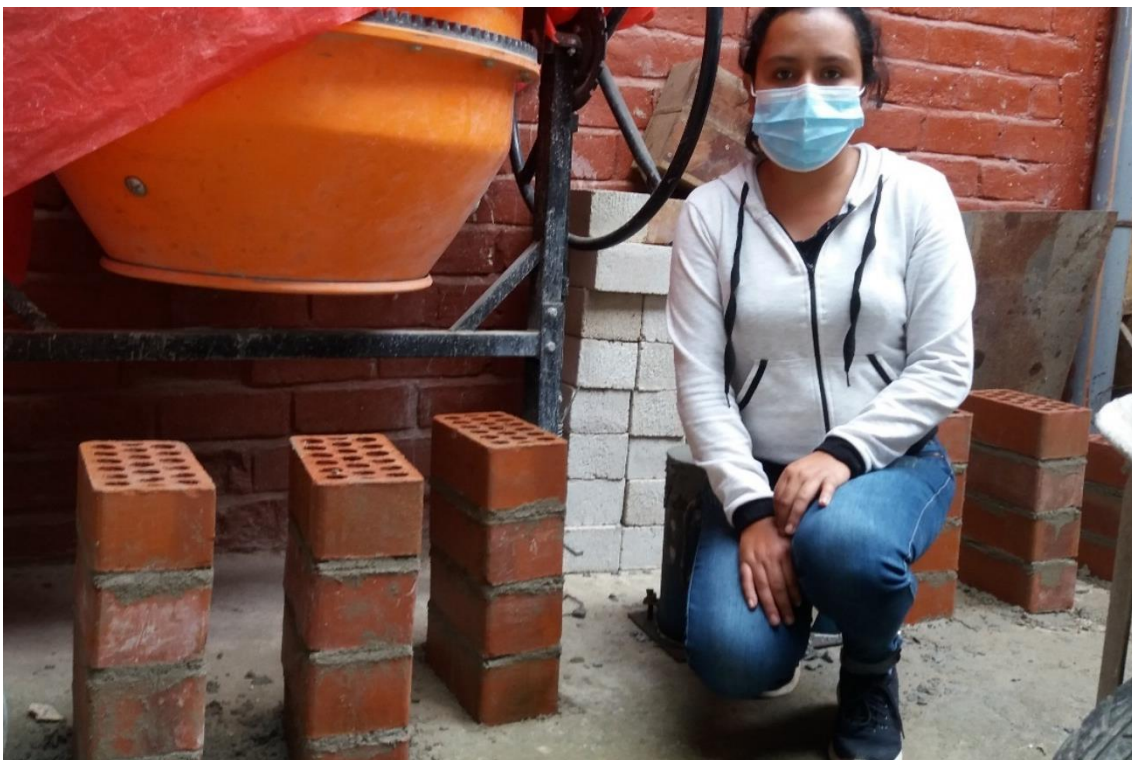
Nota: Se asientan tres ladrillos con mortero de cemento y arena para la elaboración de pilas.
