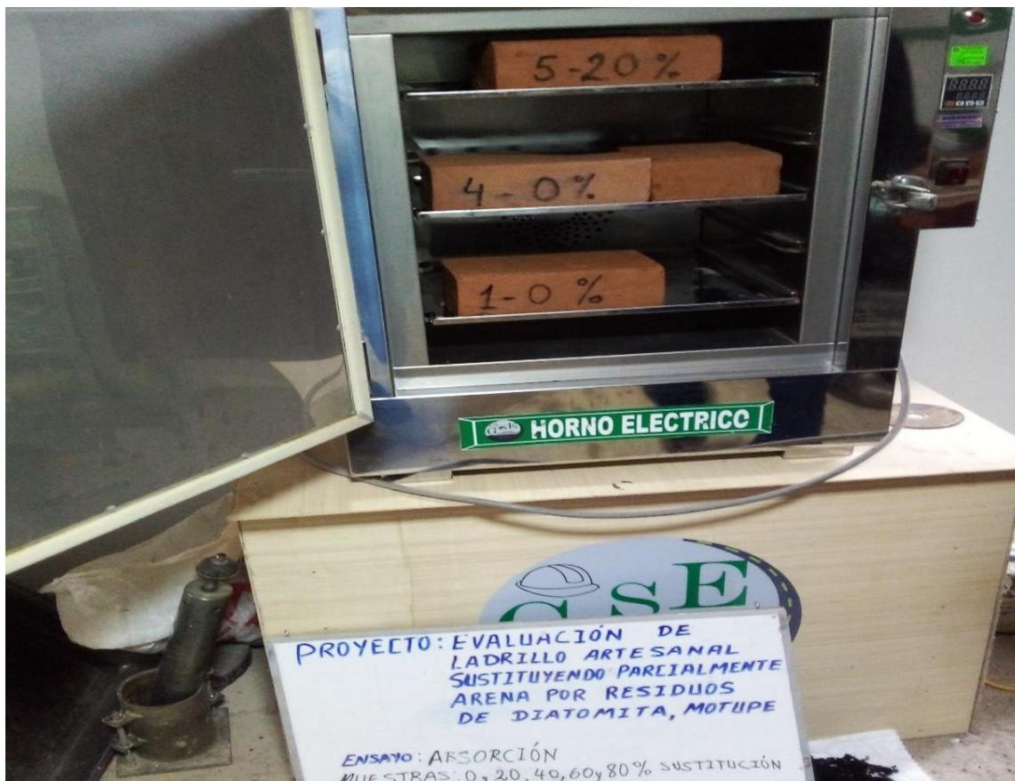
Fotografía 10. Ensayo de succión de los ladrillos.
