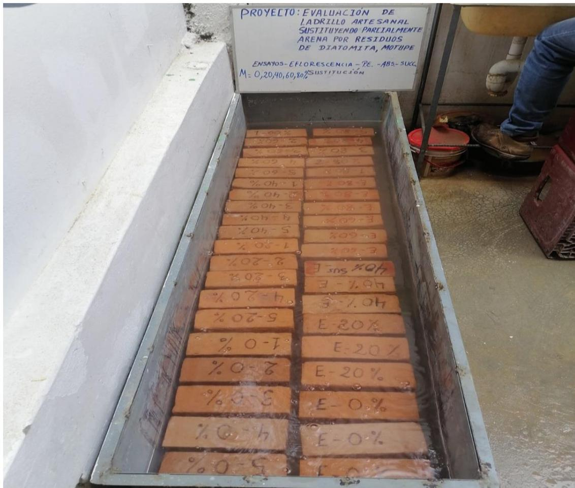
Fotografía 12. Ensayo de peso específico de los ladrillos, pesado de muestras.
