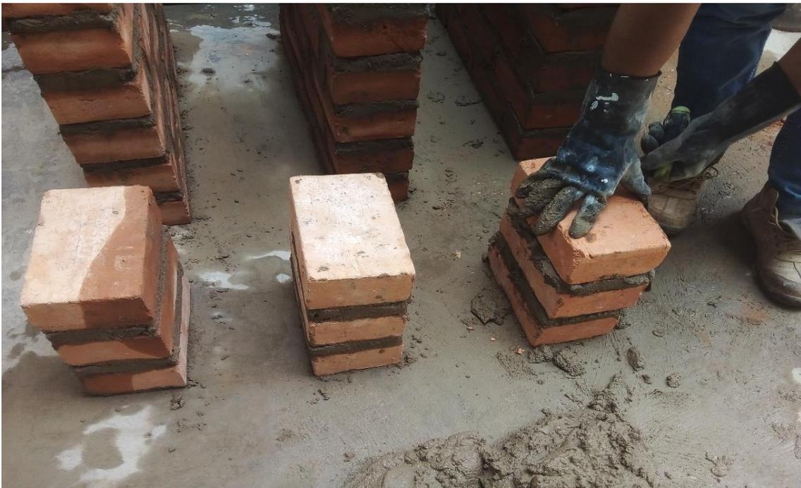
Fotografía 15. Ensayo de resistencia a la compresión en pila, ruptura de muestras.
