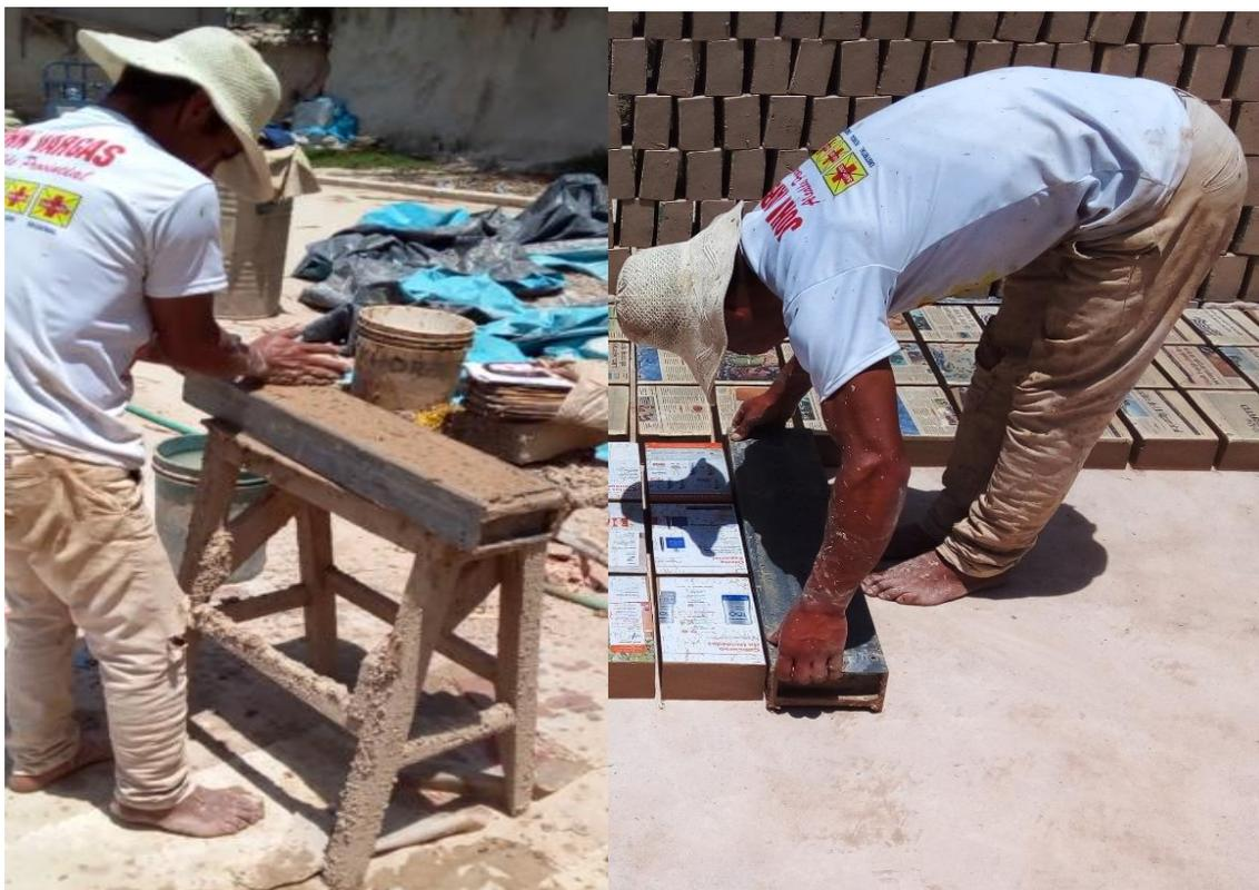
Fotografía 5. Secado de los ladrillos.
