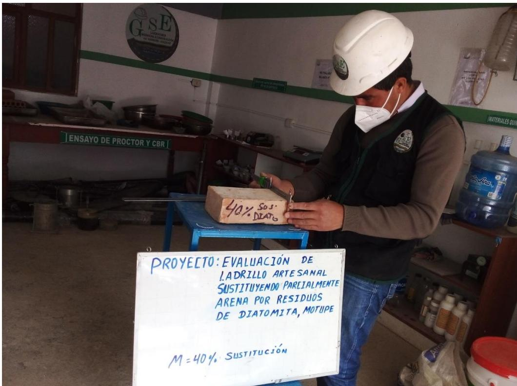
Fotografía 8. Ensayo de alabeo de los ladrillos.
