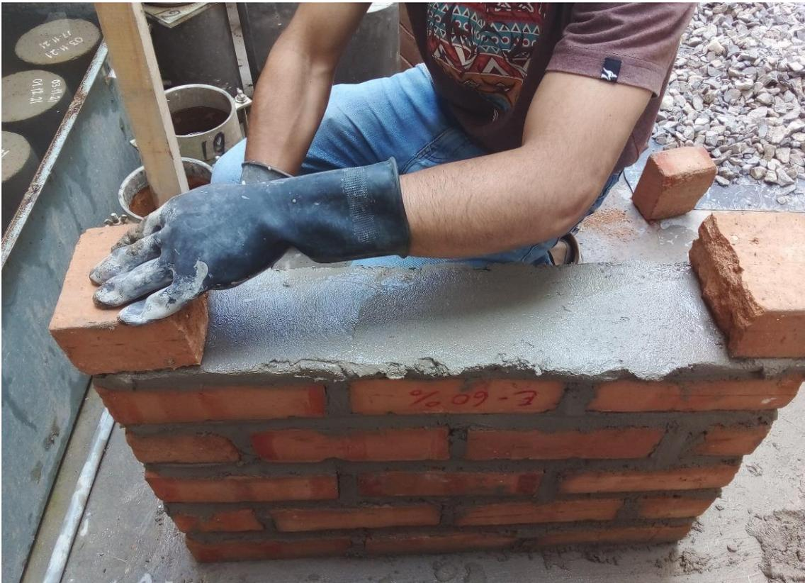
Fotografía 15. Ensayo de resistencia a la compresión en murete, ruptura de las muestras.
