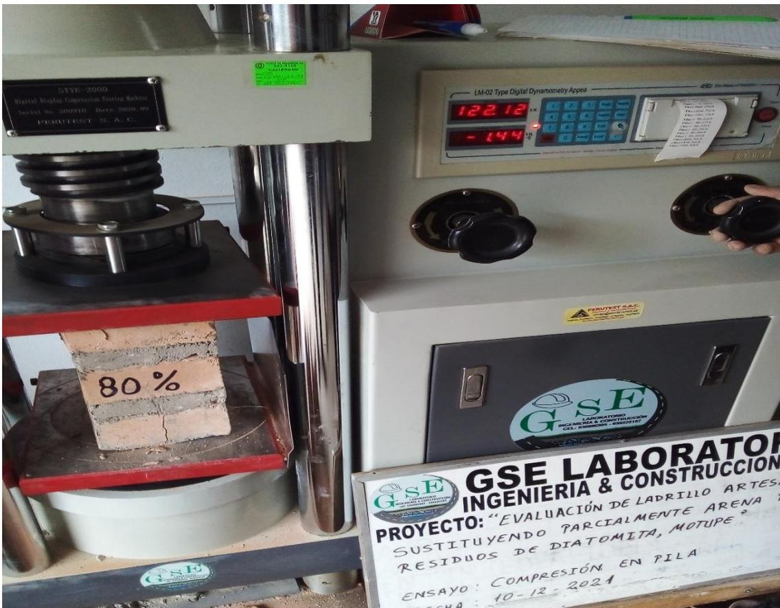
Fotografía 14. Ensayo de resistencia a la compresión en murete, elaboración de muestras.
