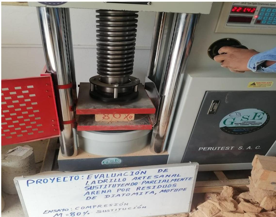
Fotografía 14. Ensayo de resistencia a la compresión en pila, elaboración de muestras.
