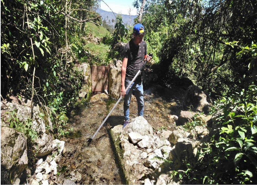
Anexo 9: Medición del caudal con un correntómetro
